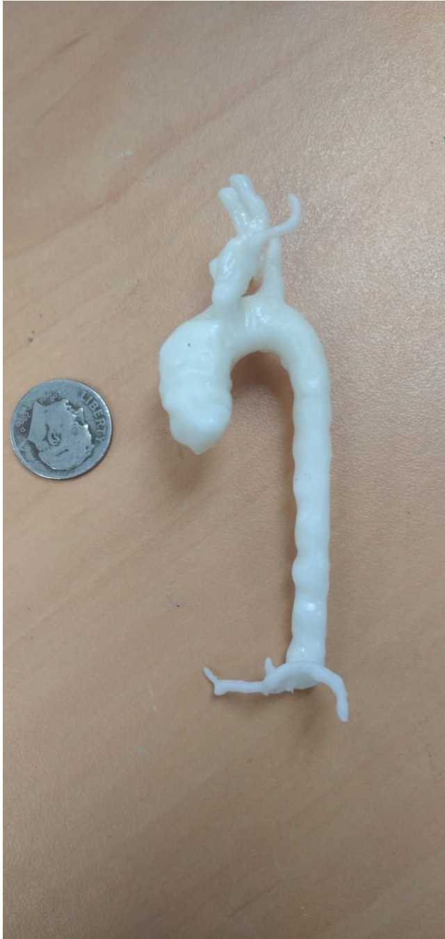
Figura 8. Modelo de aorta a escala impreso con resina líquida
