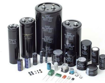
**Figura 3.6.** *Capacitores industriales de aparatos eléctricos*
