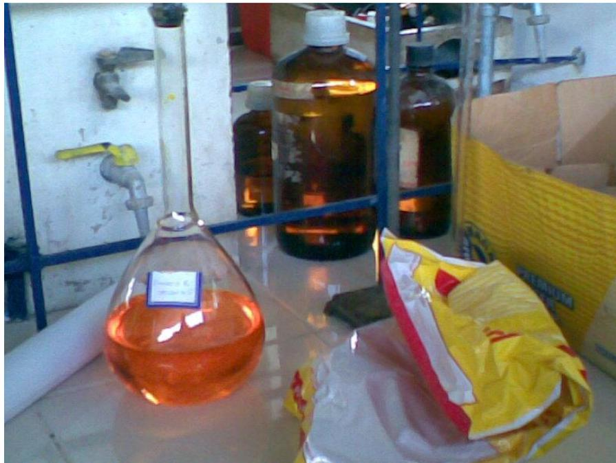
*Figura N° 30 Preparación de la solución de cromo de concentración conocida*
