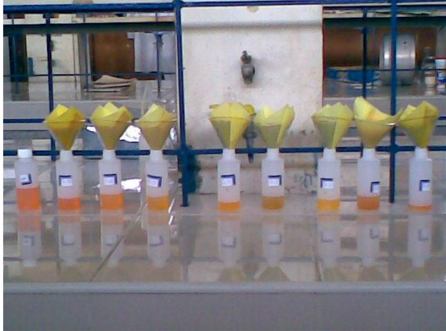
*Figura Nº 31 Filtrado de mezclas para obtener la solución óptima para la lectura en el aparato de Absorción Atómica*
