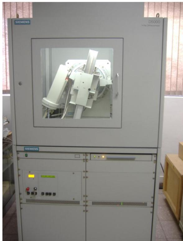
*Figura Nº 34 Equipo de Difracción de rayos X*
