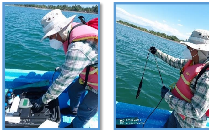
Figura 10. Determinación parámetros fisicoquímicos en la columna de agua usando la Sonda Multiparámetros HANNA HI9829. Fotos de ICSEM EL Salvador.
