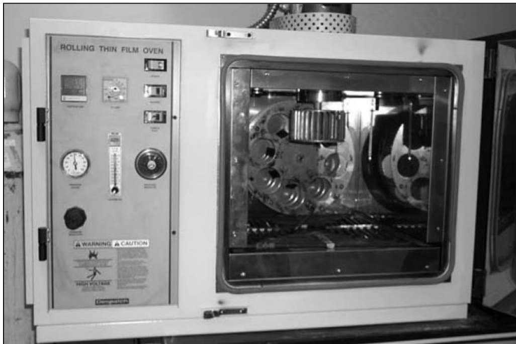
Figura 17. Horno RTFO. Se puede observar el sostén rotatorio en posición vertical, con los agujeros dispuestos para colocar las botellas de muestra. (Fuente: MS-26 Asphalt Institute)
