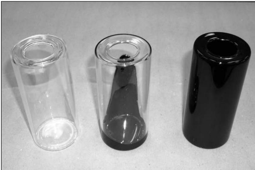
Figura 15. Botellas para muestras de RTFOT (Fuente: MS-26 Asphalt Institute)
