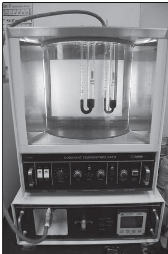
Figura 8. Baño maría para la viscosidad absoluta (Fuente: MS-26 Asphalt Institute)
