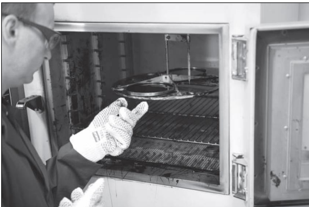
Figura 14. Ensayo TFOT (Fuente: MS-26 Asphalt Institute)
