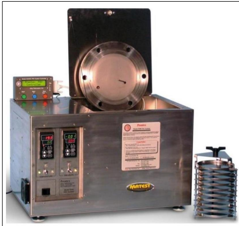
Figura 18. Vasija de Envejecimiento a Presión (PAV) (Fuente: Conferencia Curso de Mezclas Asfálticas Modificadas con polímero y caucho, Ing. Jorge Escalante Zegarra)
