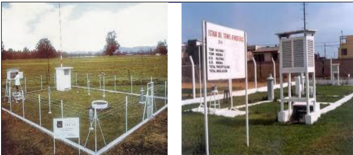
Ilustración 4. Vista de una estación meteorológica real. A la derecha se puede apreciar la caseta meteorológica, con su techo y cubierta de madera con rendijas. (Fuente: Cátedra de Hidrología, Ing. Martínez Bermúdez; UES FMOcc)
