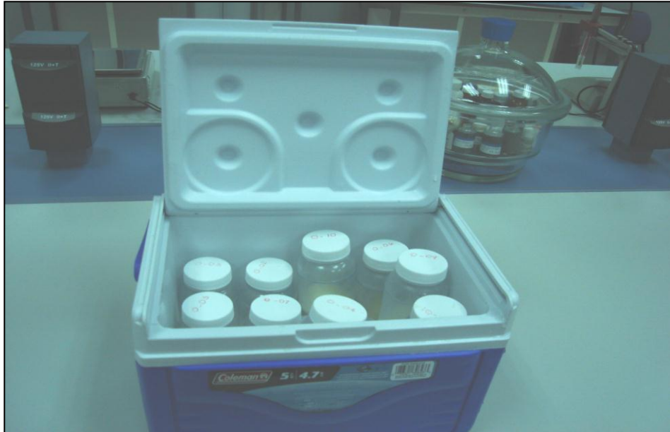
Fig N° 22 Hielera térmica para transporte de muestras
