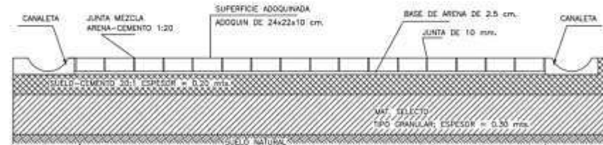
SECCION TÍPICA ADOQUINADO PARQUEO INSTITUCIONAL ESCALA 1:25
