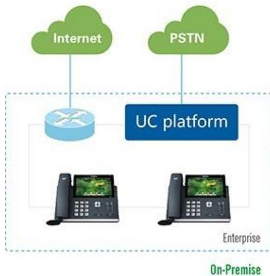
*Figura 3: Esquema de una central telefónica VoIP de instalación local (on-premise) que unifica varios medios de comunicación en una empresa (UC o Comunicaciones Unificadas)*
