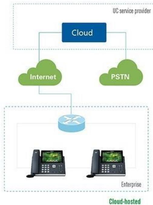
Figura 10: Esquema de una central telefónica VoIP en la nube o alojada
