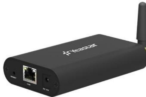
*Figura 102: Gateway GSM Yeastar TG100 utilizado para la implementación.*
