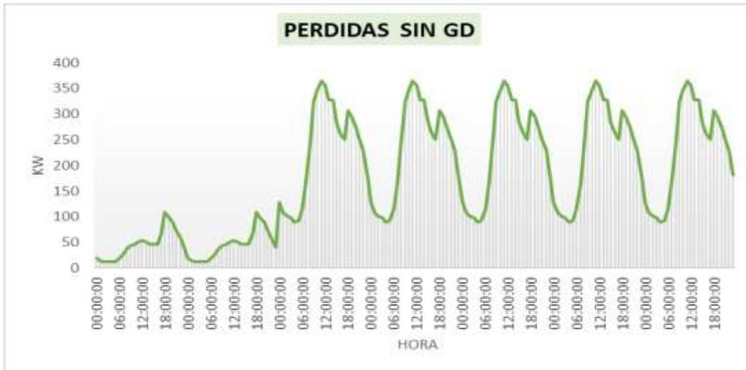
Figura 14. Pérdidas de potencia en la red a simular, sin generación distribuida.
