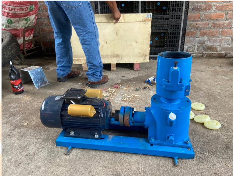
Figura 8. Peletizadora 5 Hp motor eléctrico monofásico, voltaje 110 V
