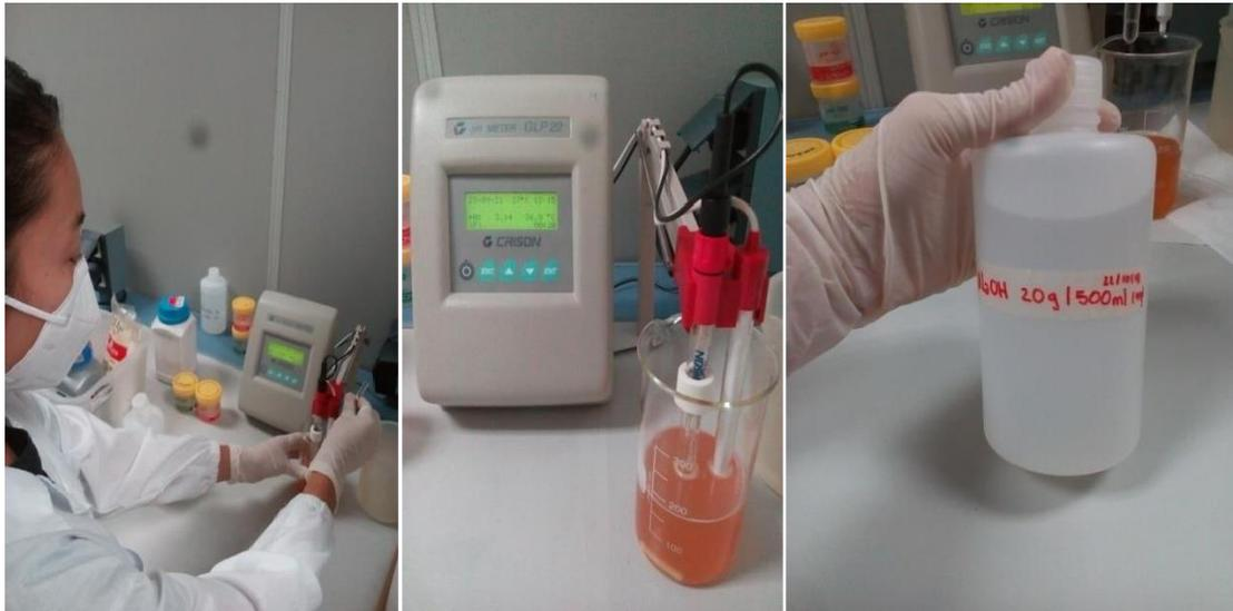
Figura 10. Ajuste del pH del medio de pulpa artificial
