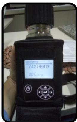
Figura 4. Medición del índice de humedad de granos
