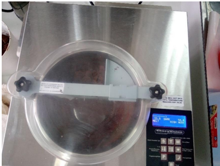
Figura A 5. Máquina atemperadora Chocovision Minirev
