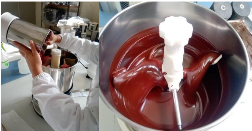
Figura 9. Elaboración de licor de cacao a partir del refinado de cacao premolido, utilizando maquina refinadora
