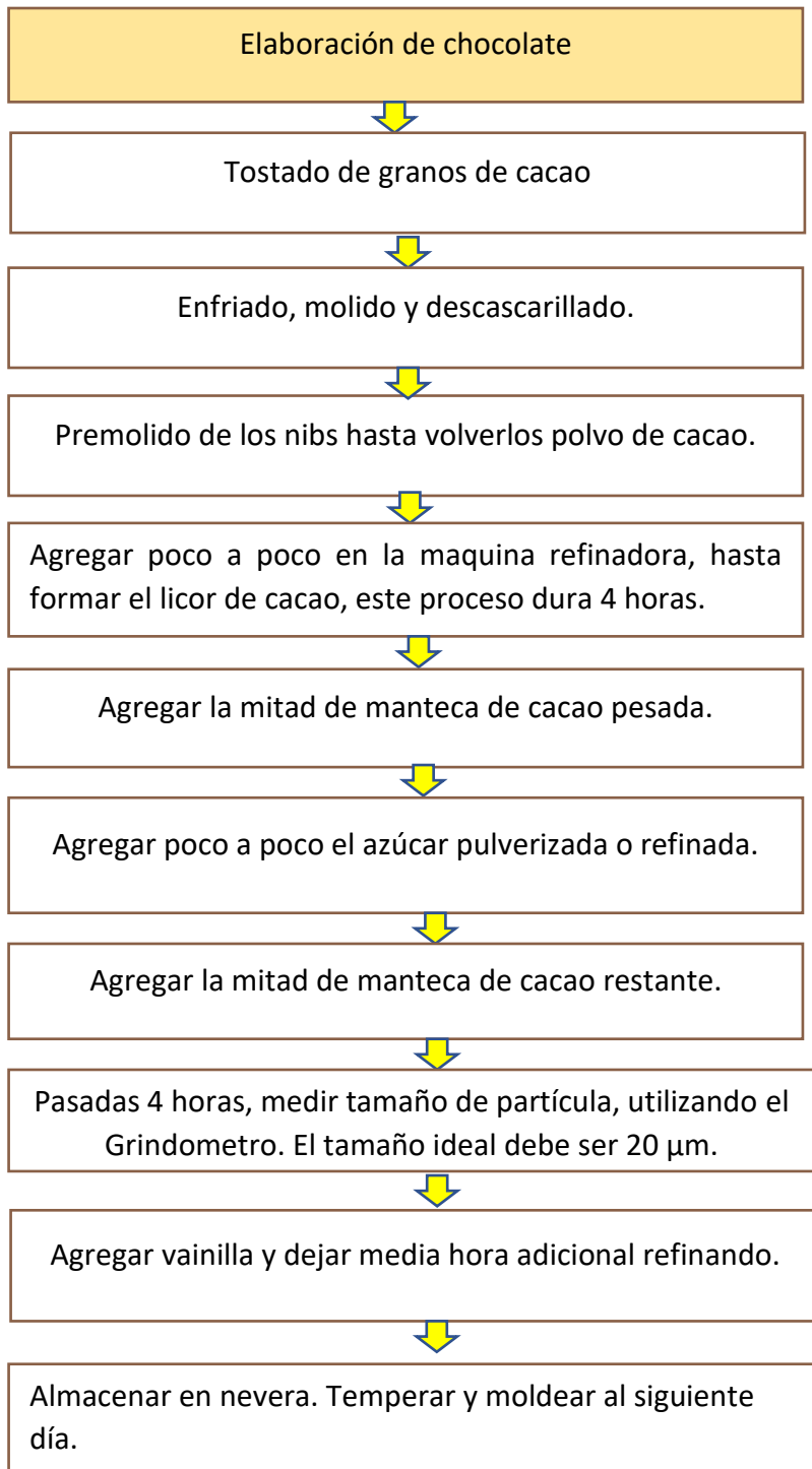
Figura 10. Esquema que muestra los pasos para la elaboración de chocolate.
