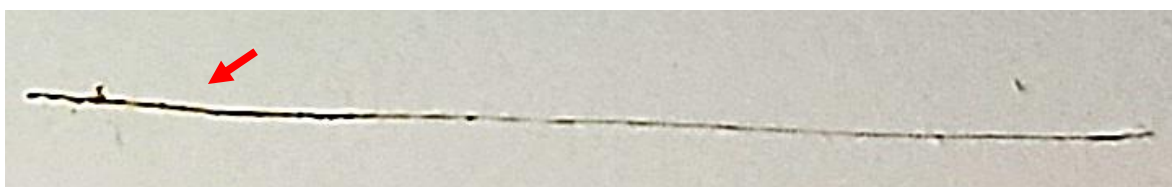
Figura A2. 13. Grado de corrosión 10-G/9-G para sistema S5PHMD.
