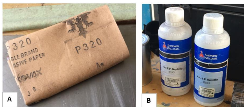
Figura 3.9. Preparación con herramienta. A) Lija grado P320. B) Solvente Naphtha.
