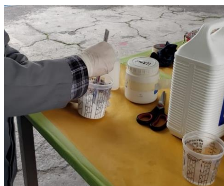
Figura 3.15. Ejemplo de preparación de mezcla: Acabado poliuretano con una reducción del 25% de acabado poliuretano.
