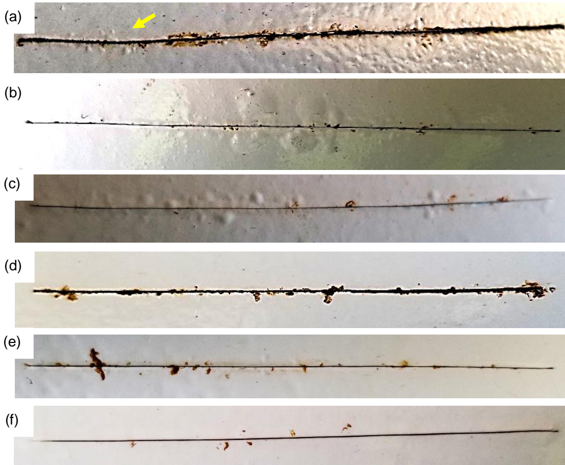
Figura A2. 6. Registros fotográficos de formación de ampollas y grados de corrosión desarrollados en los diferentes sistemas de recubrimientos.
