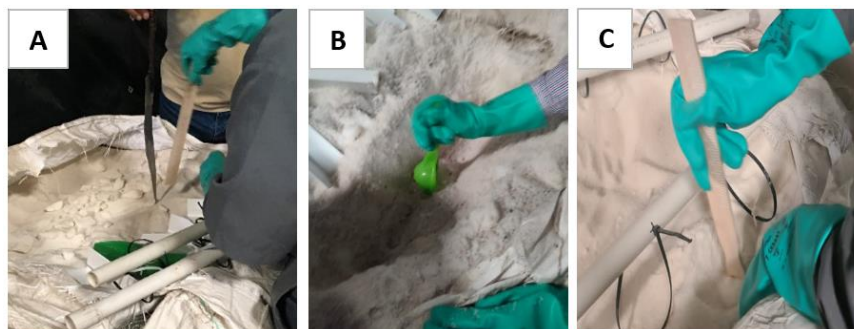
Figura 3.25. Herramientas de inmersión/extracción. A) Cuchilla, palas de plástico y de madera para Urea. B) Palas de plástico para Nitrato de Amonio. C) pala de madera para Sulfato de amonio.
