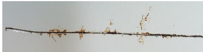
Figura 4.1. Ejemplo de línea de corte en uno de los especímenes S2PHMD a 730 horas de inmersión.
