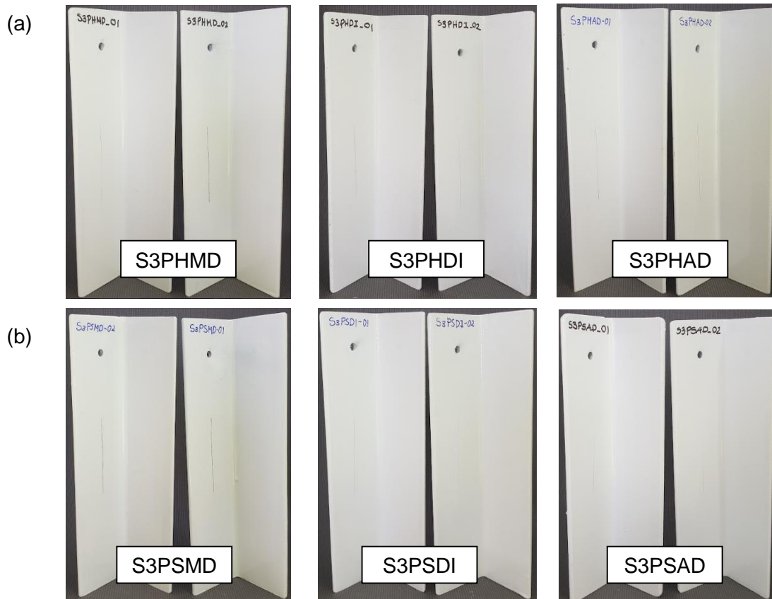
Figura A2. 8. Especímenes en sus condiciones iniciales antes de colocarse por inmersión en Sulfato de amonio.
