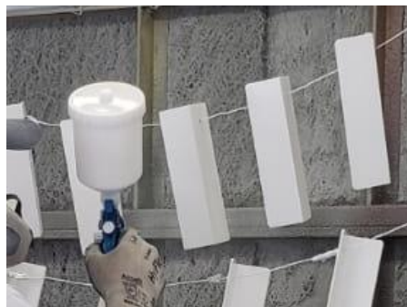
Figura 3.16. Equipo de aplicación: Pistola de aspersión por gravedad.
