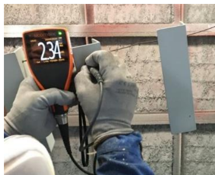
Figura 3.17. Medición de espesor de película seca con equipo ELCOMETER.
