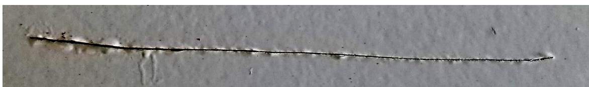
Figura A2. 14. Ampollas observadas para S5PHMD a las 1000 horas de inmersión.
