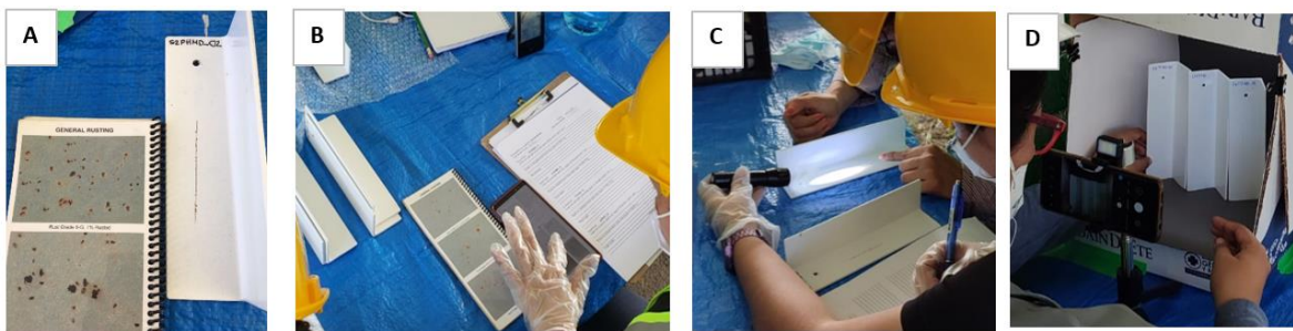
Figura 3.30. Procedimiento de monitoreo de la corrosión A) Evaluación con Norma SSPC-VIS2. B) Evaluación con norma ASTM-D714. C) Observaciones generales. D) Registro fotográfico.
