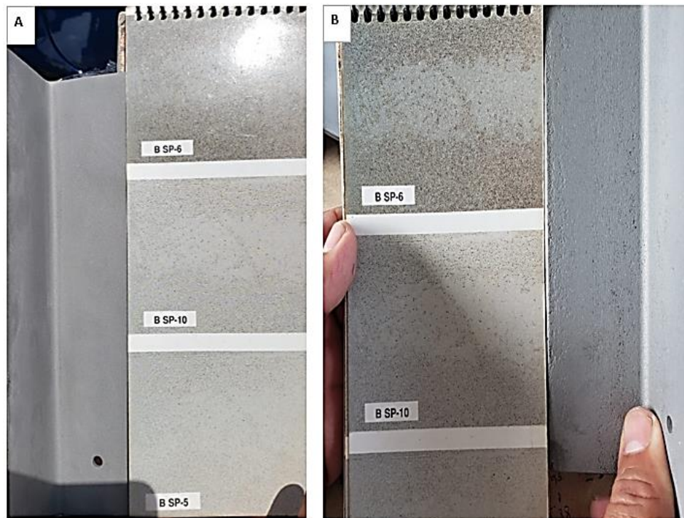
Figura 3.13. Ejemplos de piezas granalladas. A) Grado de corrosión B SP-5. B) Grado de corrosión B SP-10.
