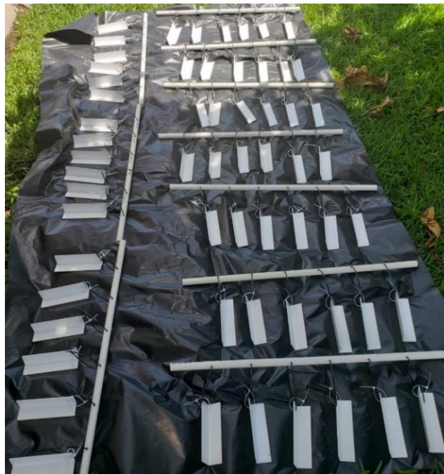
Figura 3.22. Especímenes listos para inmersión.
