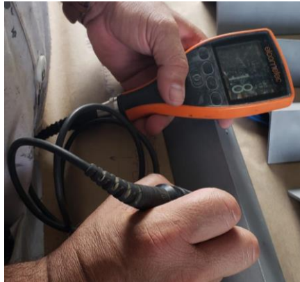
Figura 3.14. Medición de perfil de superficie para las piezas con preparación por sandblasting.
