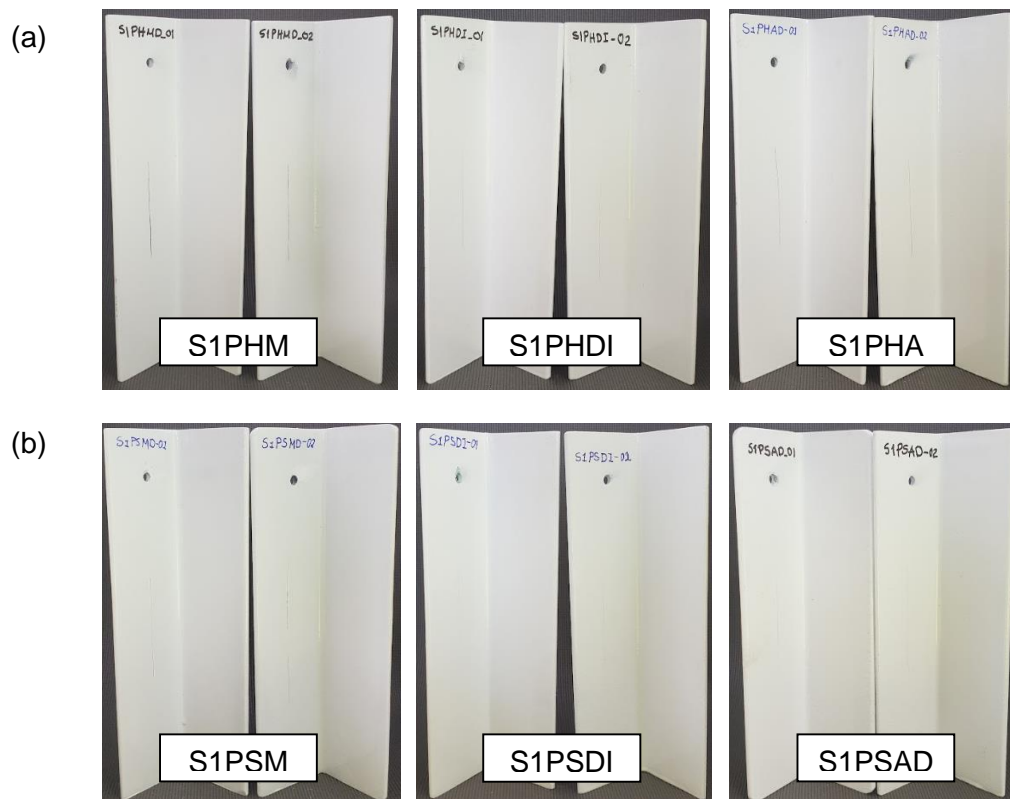
Figura A2. 2. Especímenes en sus condiciones iniciales antes de colocarse por inmersión en Urea.
