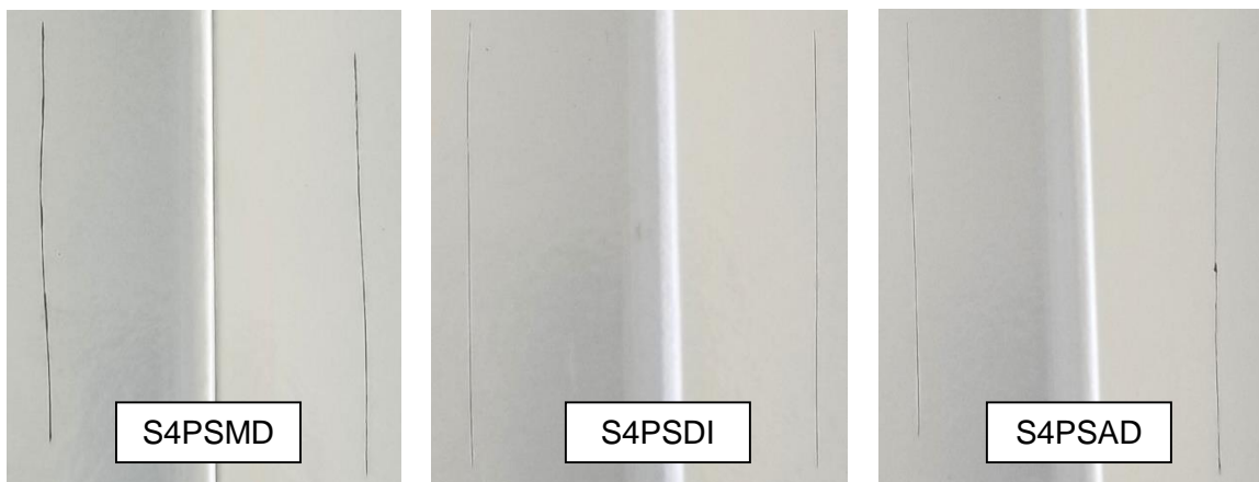
Figura A2. 11. Comparativa de líneas de corte luego de 1000 horas de exposición en DAP.
