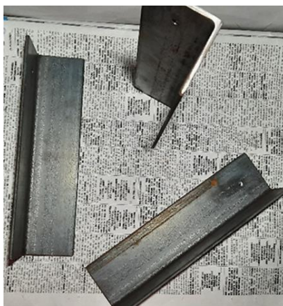
Figura 3.8. Piezas de acero posterior al proceso de corte y preparación.
