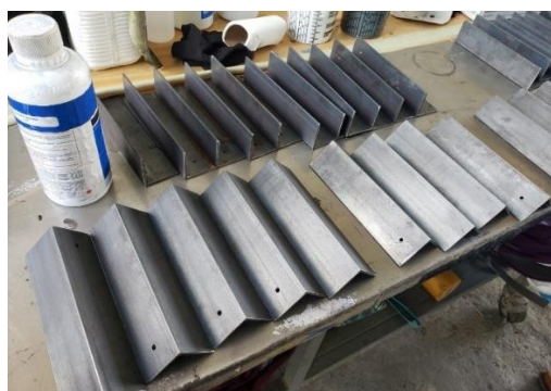
Figura 3.10. Piezas preparadas con herramienta para la aplicación del recubrimiento.
