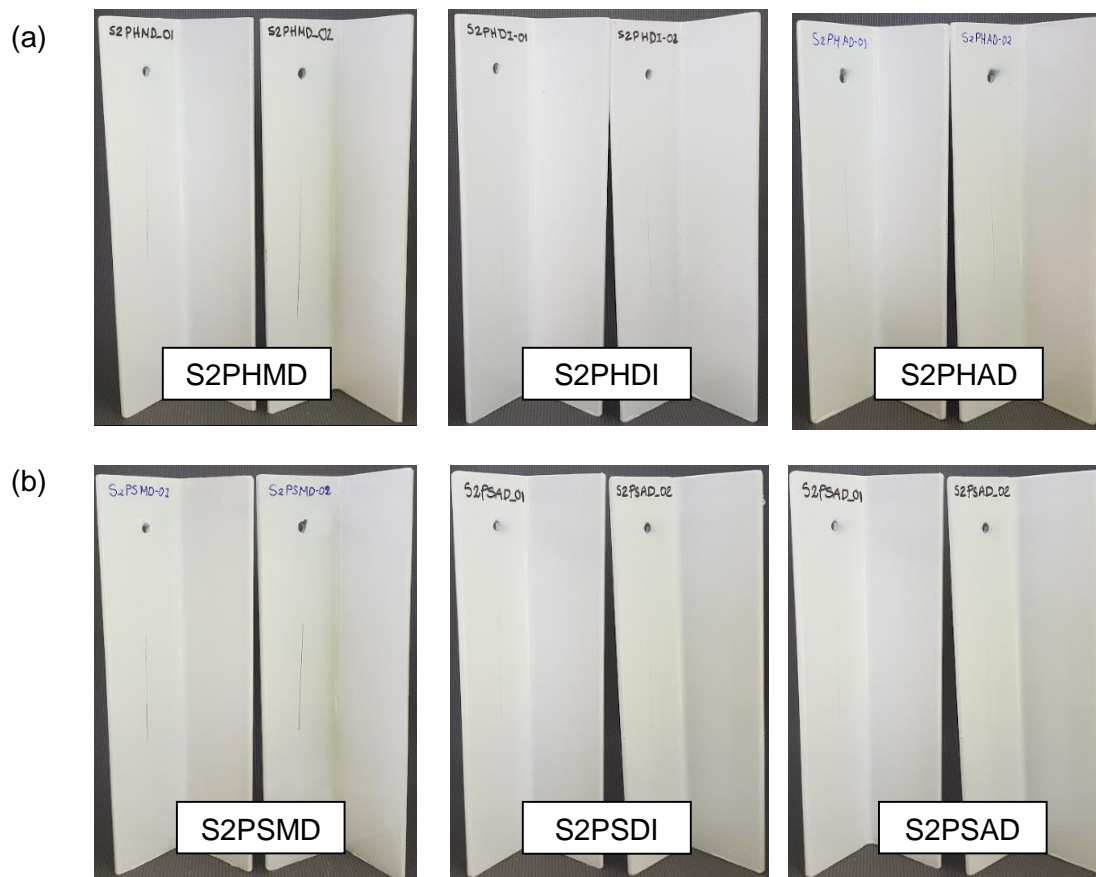
Figura A2. 5. Especímenes en sus condiciones iniciales antes de colocarse por inmersión en Nitrato de amonio.
