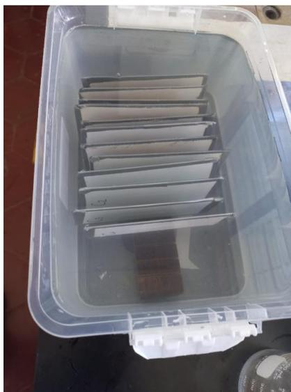
**Figura 3-4.** Cámara salina en proceso de montaje con muestras introducidas.
