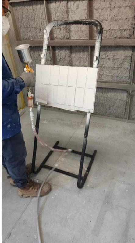
**Figura 3-3.** Aplicación de segunda capa a sistema anticorrosivo a sus respectivas muestras.
