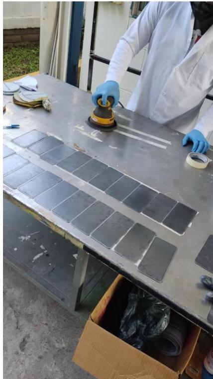
**Figura 3-1.** Especímenes luego de limpieza con lijas grano 180 y 220.
