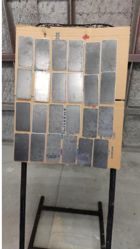
**Figura 3-2.** Especímenes una vez finalizados el proceso de limpieza aplicando nafta con paño.
