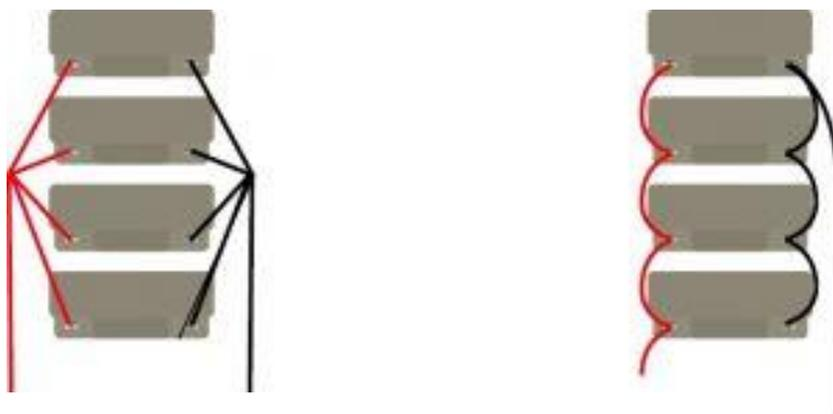
*Figura 72 Conexión de bancos correcto. Fuente: Como calcular y diseñar un banco de baterías, mayo 2020*
