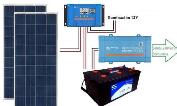
Figura 15 Instalación de un inversor en paneles solare. Fuente: EcoFener.
