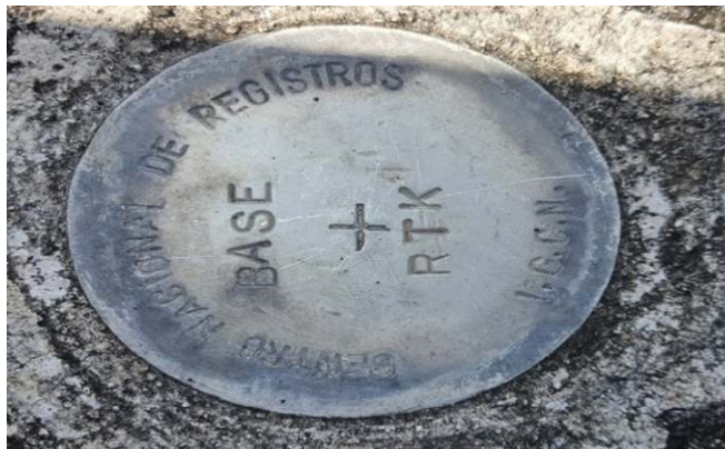
Figura 21. Mojón geodésico ubicado en la azotea de la Biblioteca de la Facultad de Ingeniería y Arquitectura,
