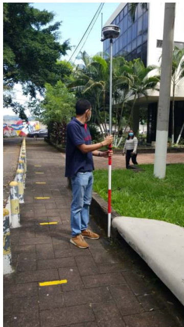
Figura 48. Levantamiento con GPS usando la técnica RTK. Fuente: Propia.
