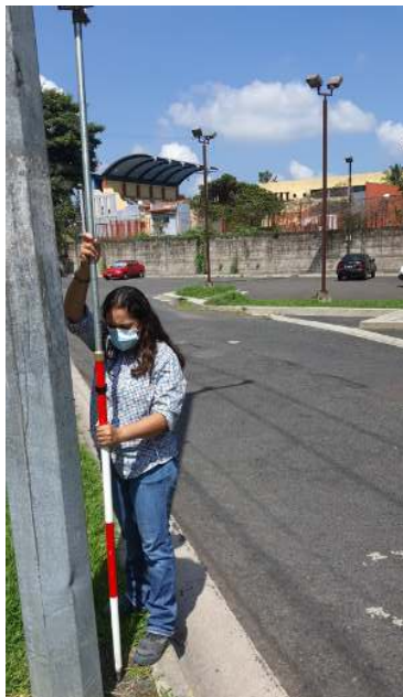
Figura 28. Levantamiento con equipo GPS para Puntos de Control Fotogramétrico, en zona de parqueo frente a biblioteca FIAUES. Fuente: Propia.
