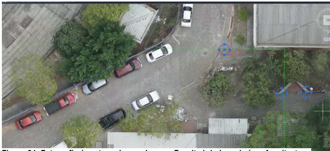
Figura 34. Fotografía área tomada por dron en Facultad de Ingeniería y Arquitectura, UES. Disposición de los puntos de control y de paso a tomar en zona de cancha de basquetbol (el hoyo). Fuente: Ing. Wilfredo Amaya Zelaya.
