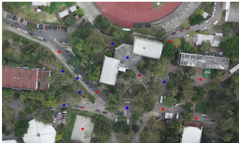
Figura 23. Designación de Puntos a ser levantados Puntos de Control Fotogramétricos (color azul) y Puntos de Control (color rojo) en la zona designada (zona 6). Fuente: Ing. Wilfredo Amaya Zelaya.
