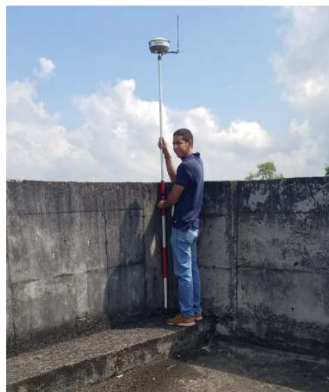
Figura 25. Levantamiento con equipo GPS para Puntos de Control Fotogramétrico. Fuente: Propia.
