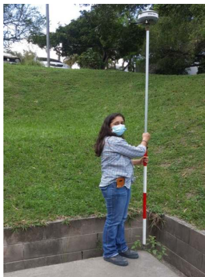
Figura 26. Levantamiento con equipo GPS para Puntos de Control Fotogramétrico, en cancha de basquetbol, el hoyo. Fuente: Propia
