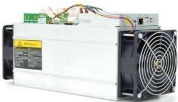
*Ilustración 5: equipo informático ASIC<sup>40</sup>*
