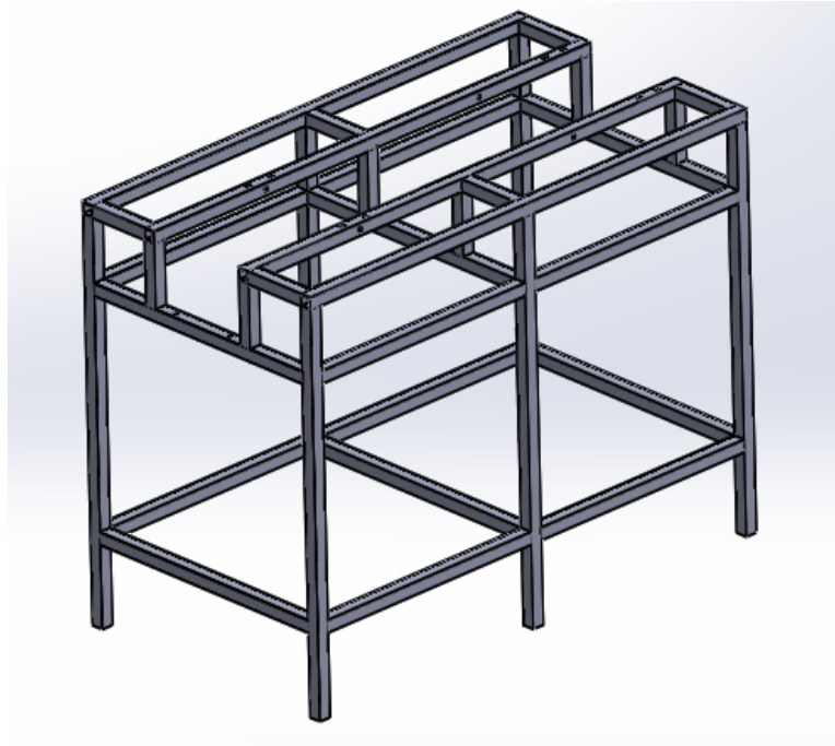
Figura 55. Estructura de soporte de banda transportadora Fuente: Elaboración propia.
