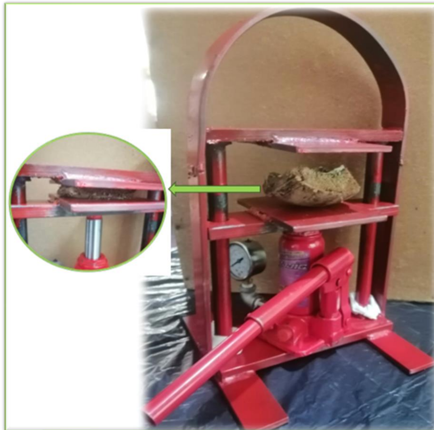
Figura 1- 8. Una pequeña prensa hidráulica construida para realizar el ensayo de carga estática. Fuente: Elaboración propia.
