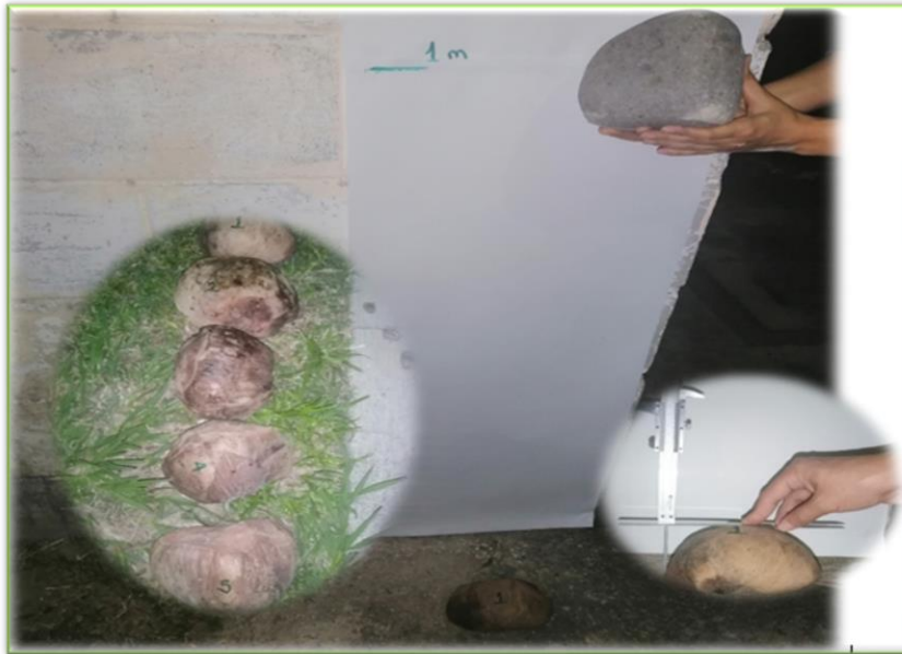
Figura 1- 10. Ensayo de impacto con peso W y toma de alturas. Fuente: Elaboración propia.
