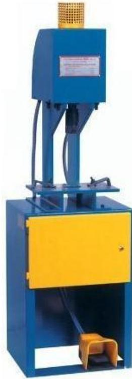
Fig. 1.6. Prensa neumática [5].
