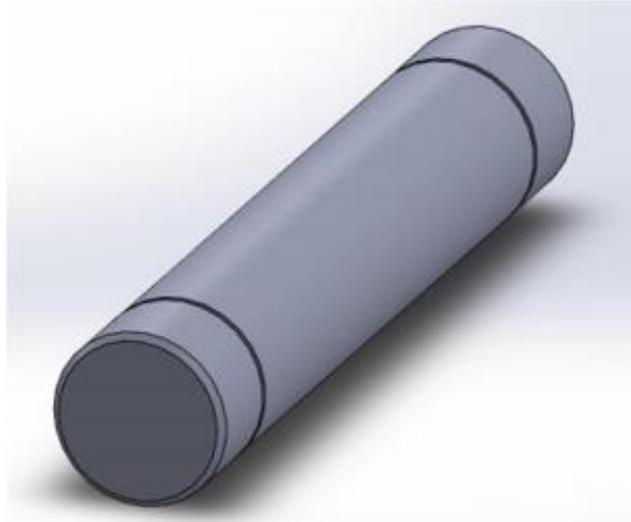
Fig. 2.10. Eje de rodillo [9].
