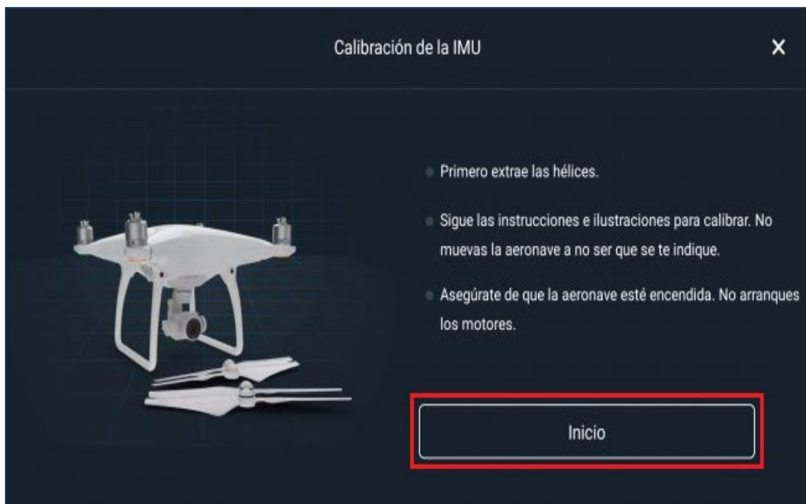
Imagen No. 3 - 19 Iniciar Calibración de la IMU.
