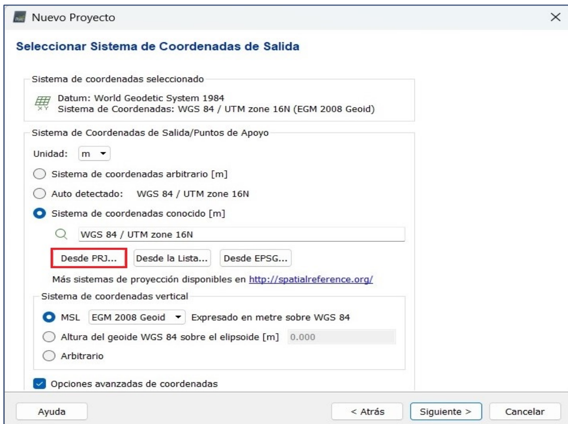
Imagen No. 4 - 6 Menú de selección de sistema de coordenadas de salida.
