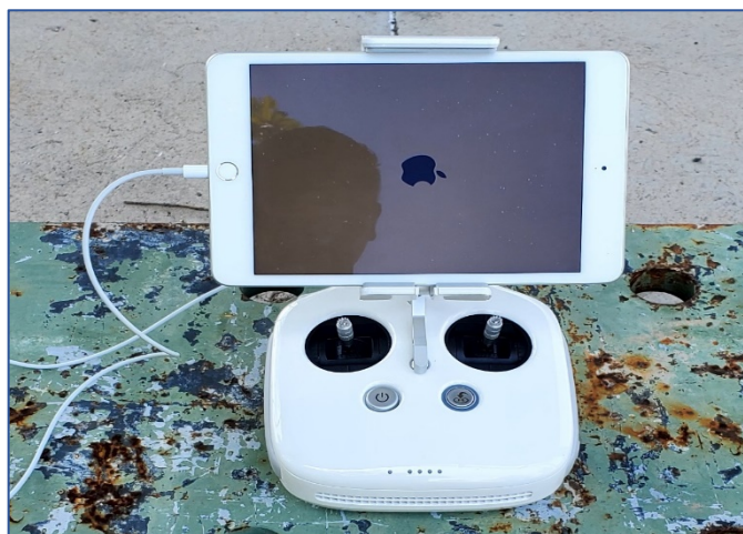
Imagen No. 3 - 14 Conectar iPad al controlador.
