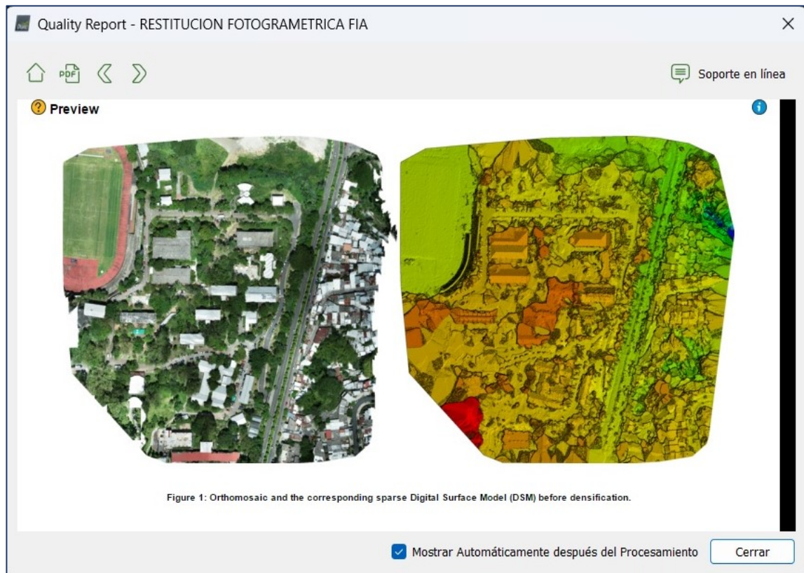
Imagen No. 4 - 16 Vista Previa del Ortomosaico y DSM.
