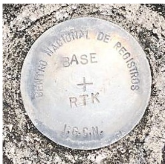
Imagen No. 3 - 45 Vértice Geodésico “BASE RTK BIBLIOTECA”
