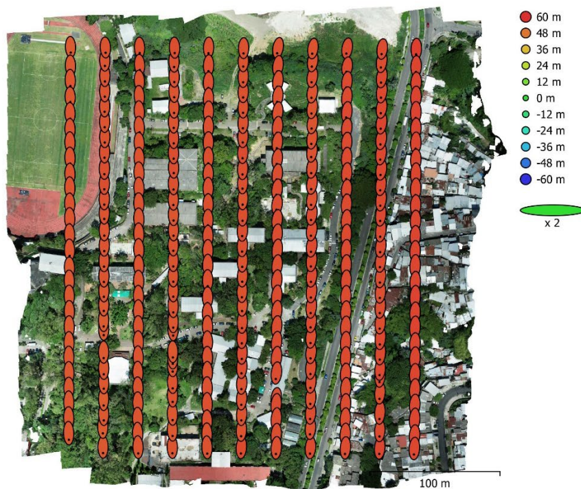
Fig. 3. Posiciones de cámaras y estimadores de error. El color indica el error en Z mientras el tamaño y forma de la elipse representan el error en XY. Posiciones estimadas de las cámaras se indican con los puntos negros.
