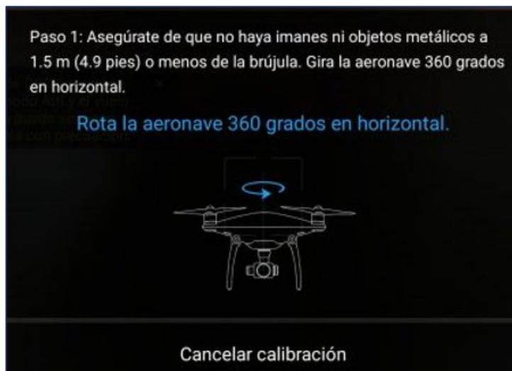
Imagen No. 3 - 28 Rotar el dron 360 grados en horizontal.
