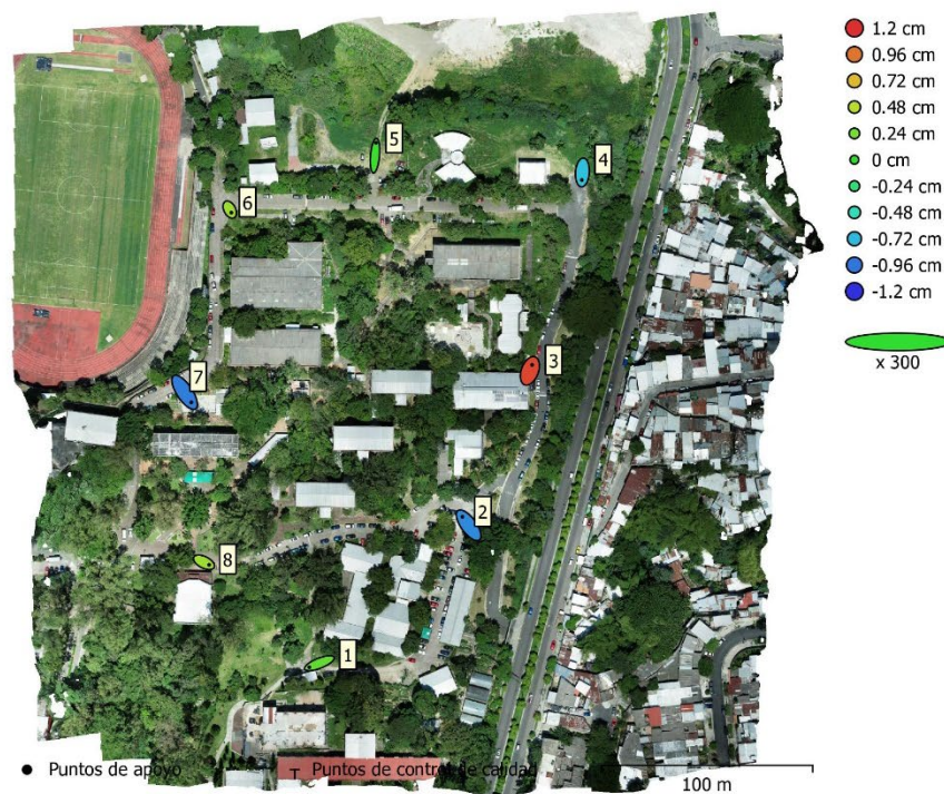
Fig. 4. Posiciones de puntos de apoyo y estimaciones de errores.
