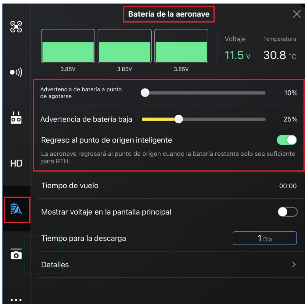
Imagen No. 3 - 35 Batería de la aeronave.
