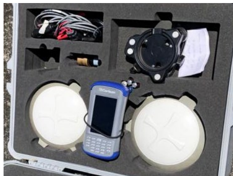
Imagen No. 3 - 44 Equipo GNSS y Colector Fuente: Elaboración propia.
