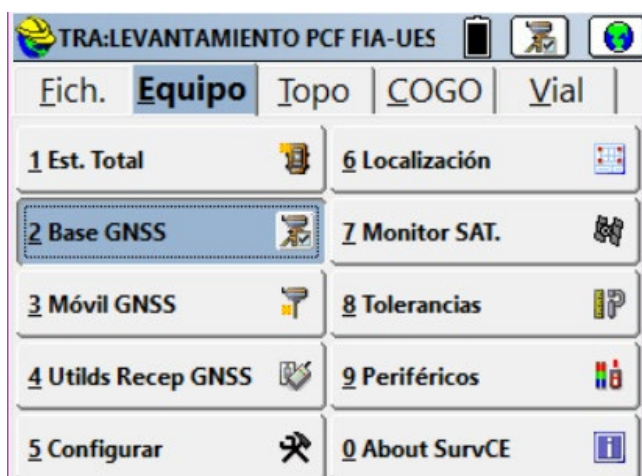
Imagen No. 3 - 54 Selección de punto para configuración de Base GNSS
