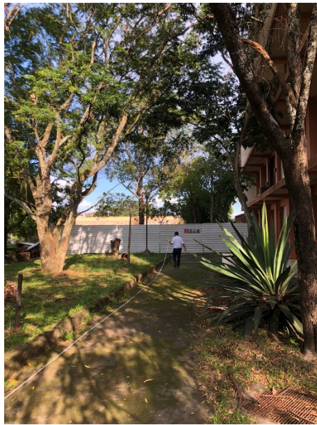
Imagen No. 3 - 72 Fotografía de la medición de detalles con cinta de 50 metros.
