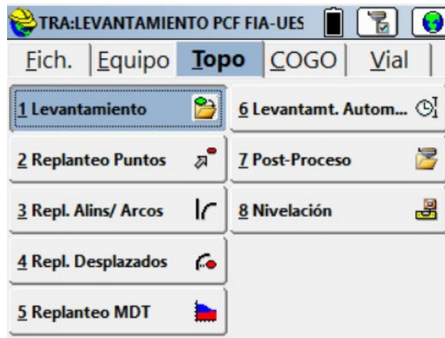
Imagen No. 3 - 68 Selección de opción “Levantamiento” en pestaña Topo
