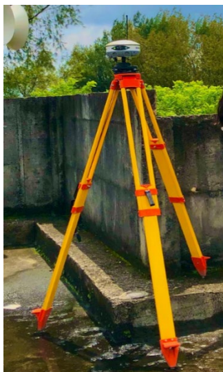
Imagen No. 3 - 46 Base GNSS
