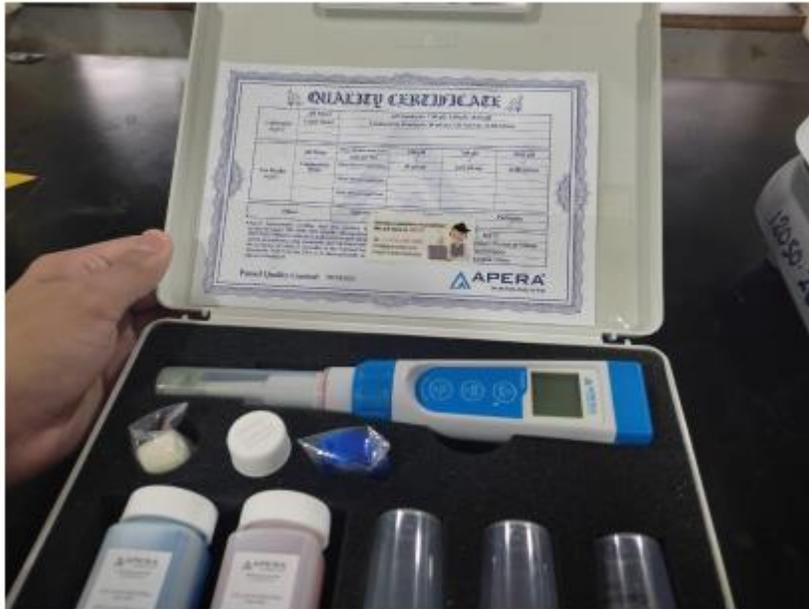
Imagen 7 pH-metro portátil proporcionado por Planta Piloto.
