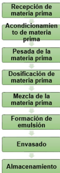
**Figura 4.6** Diagrama de flujo del proceso semiindustrial
