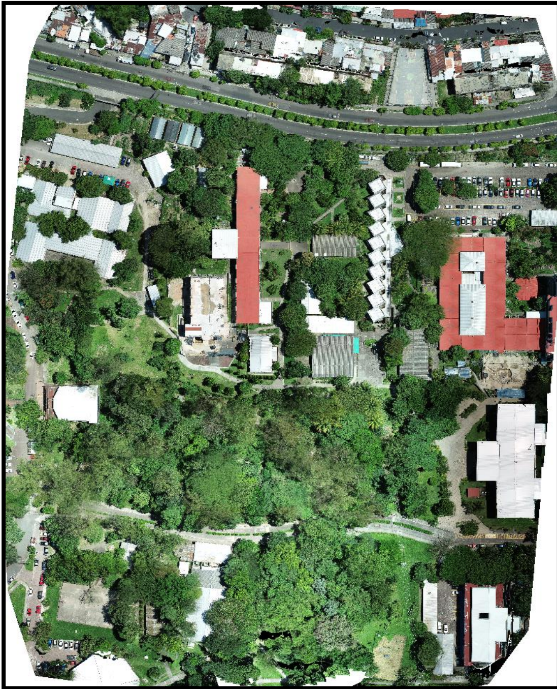
FIGURA 76: RESULTADO DE ORTO MOSAICO DE LA FACULTAD DE CIENCIAS AGRONÓMICAS. FUENTE: PROPIA PIX4D-MAPPER
