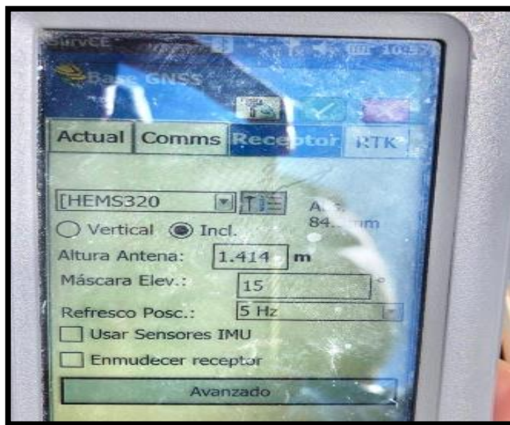
FIGURA 32: CONFIGURACIÓN DE ALTURA DE ANTENA. FUENTE: FOTOGRAFÍA TOMADA EN CAMPO
