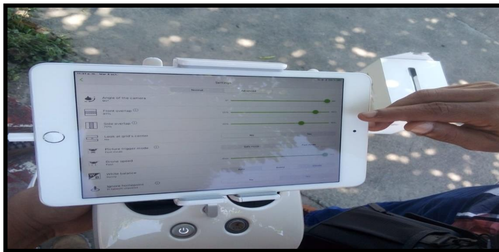
FIGURA 51: CONFIGURACIÓN DE PARÁMETROS EN PIX4D-CAPTURE. FUENTE: FOTOGRAFÍA TOMADA EN CAMPO
