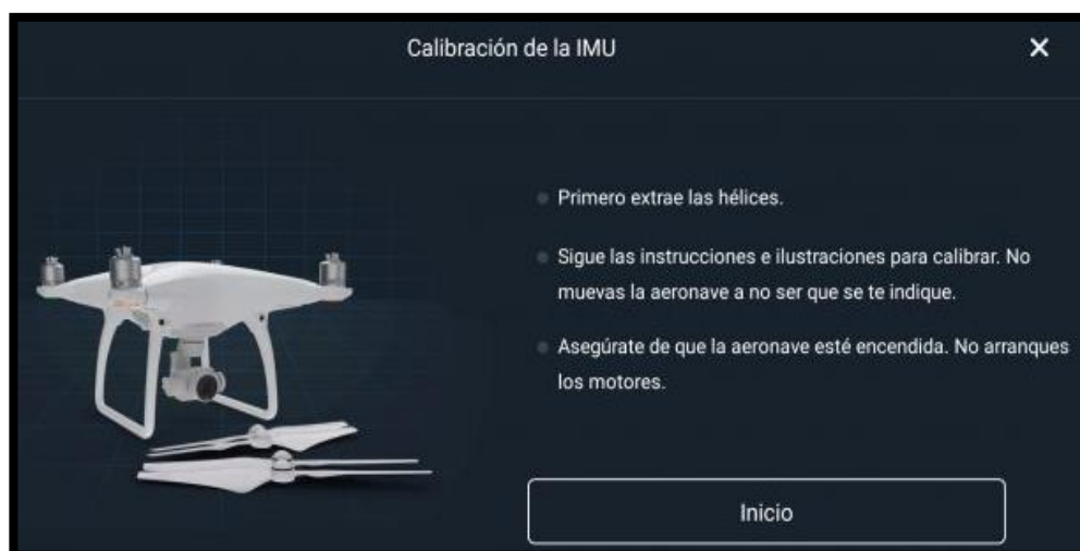
FIGURA 38: CALIBRACIÓN DE LA IMU. FUENTE: CURSO TELEDETECCIÓN https://www.cursosteledeteccion.com/calibra-la-imu-y-la-brujula-en-nuestro-dron-dji/
