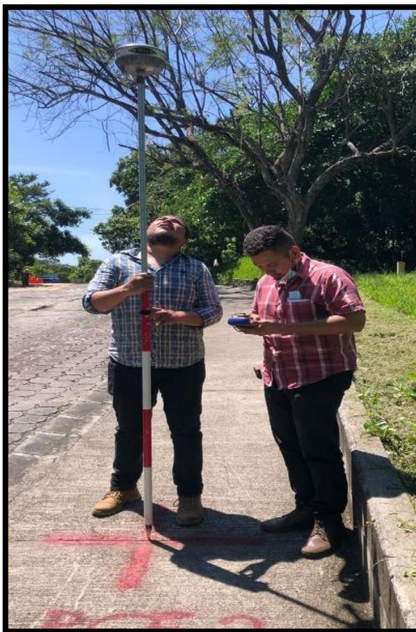
FIGURA 11: LEVANTAMIENTO TOPOGRÁFICO CON RECEPTOR RTK. FUENTE: PROPIA - FOTOGRAFÍA TOMADA EN CAMPO
