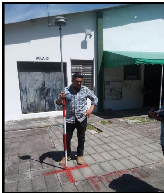
FIGURA 34: UBICACIÓN ESTRATÉGICA DE LOS PUNTOS DE CONTROL FOTOGRAMÉTRICOS. FUENTE: FOTOGRAFÍA TOMADA EN CAMPO
