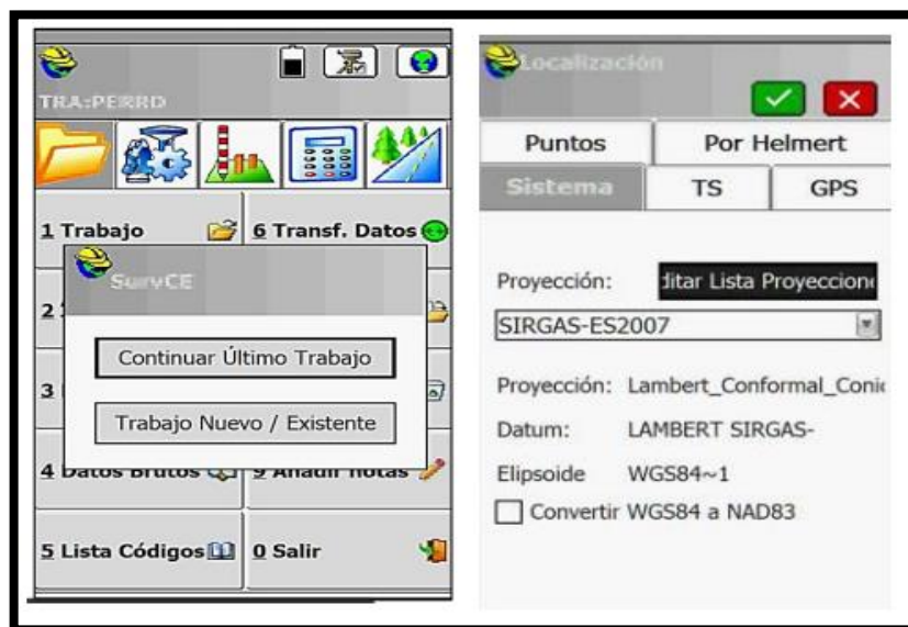
FIGURA 31: SELECCIÓN DE TRABAJO NUEVO. FUENTE: ING. WILFREDO AMAYA ZELAYA (2021) MANUAL DE OPERACIÓN EQUIPO GPS CARLSON
