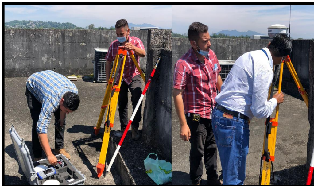
FIGURA 29: INSTALACIÓN DE EQUIPO SOBRE PUNTO GEODÉSICO. FUENTE: FOTOGRAFÍA TOMADA EN CAMPO
