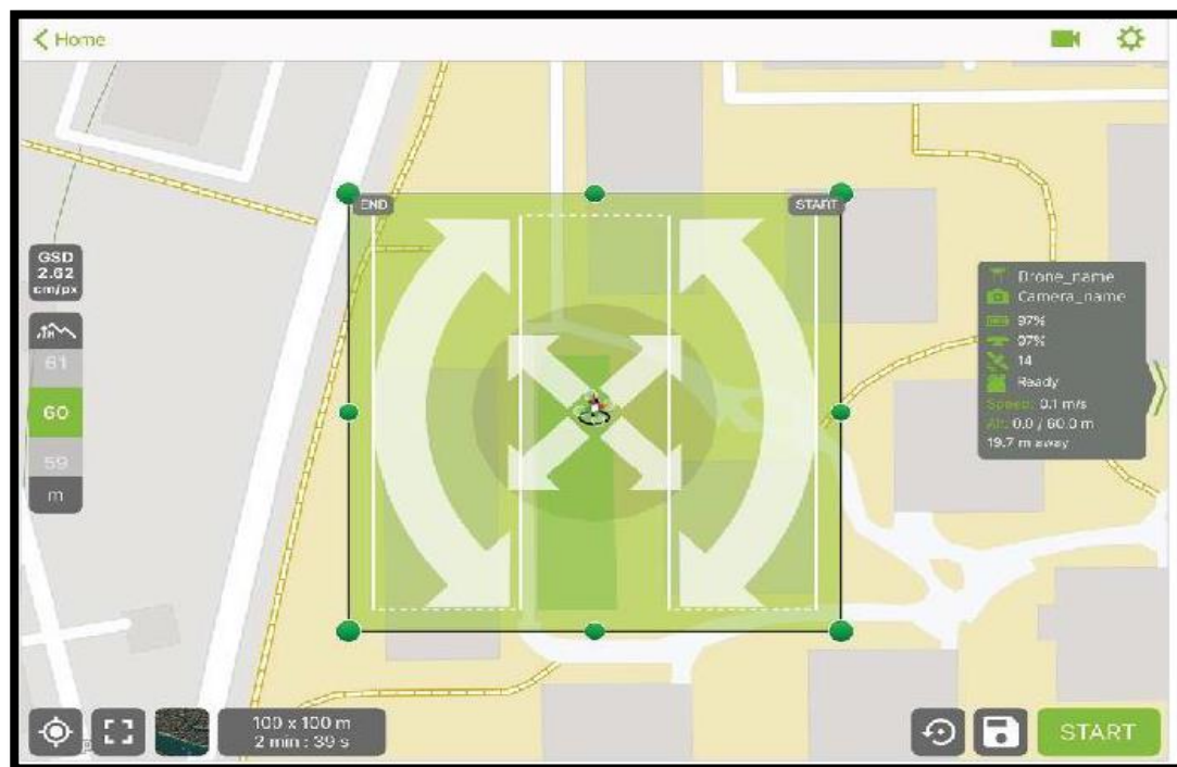
FIGURA 47: AJUSTE DEL TAMAÑO DE NUESTRO PLAN DE VUELO. FUENTE: PROPIA
