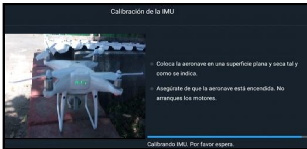
FIGURA 39: COLOCAR DRON SOBRE UNA SUPERFICIE PLANA. FUENTE: CURSO TELEDETECCIÓN https://www.cursosteledeteccion.com/calibra-la-imu-y-la-brujula-en-nuestro-dron-dji/
