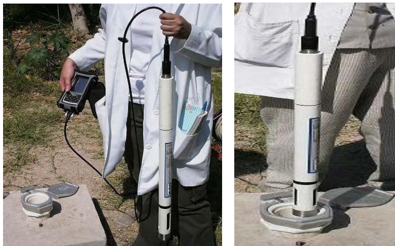
Figura N° 19: Multisonda conectada al demo (derecha) Introducción de la Multisonda al pozo (izquierda).
