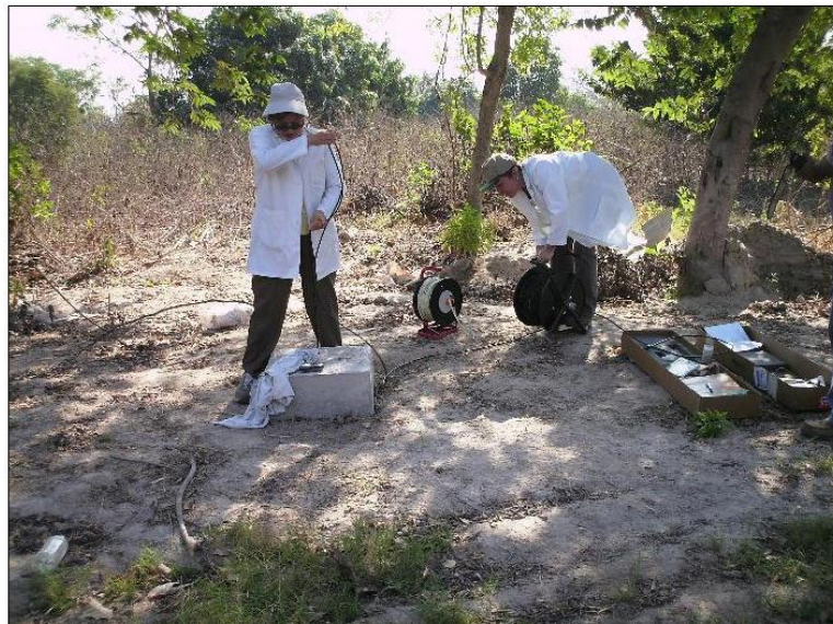
Figura 32: Introducción de la Multisonda en pozo de Manantiales
