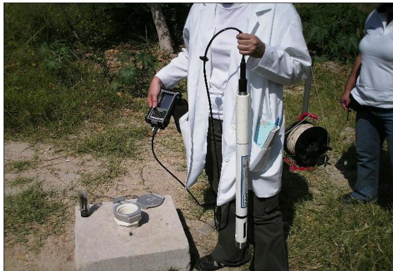
Figura 30: Equipo utilizado para las mediciones sonda Multiparamétrica; pozo de Parque Chantecuan
