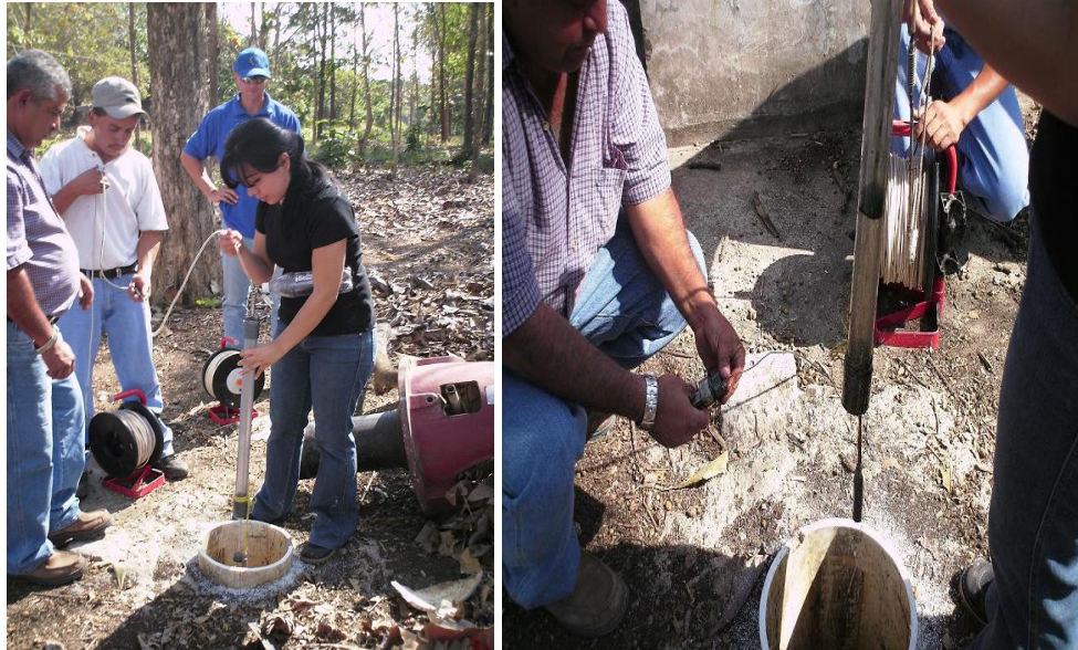
Figura 29: Introducción del Muestreador al pozo propiedad del CENTA
