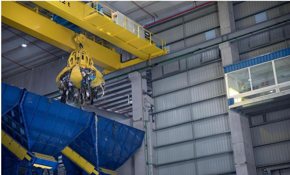
Figura 3.3. Grúa depositando desechos en las bandas de alimentación.
