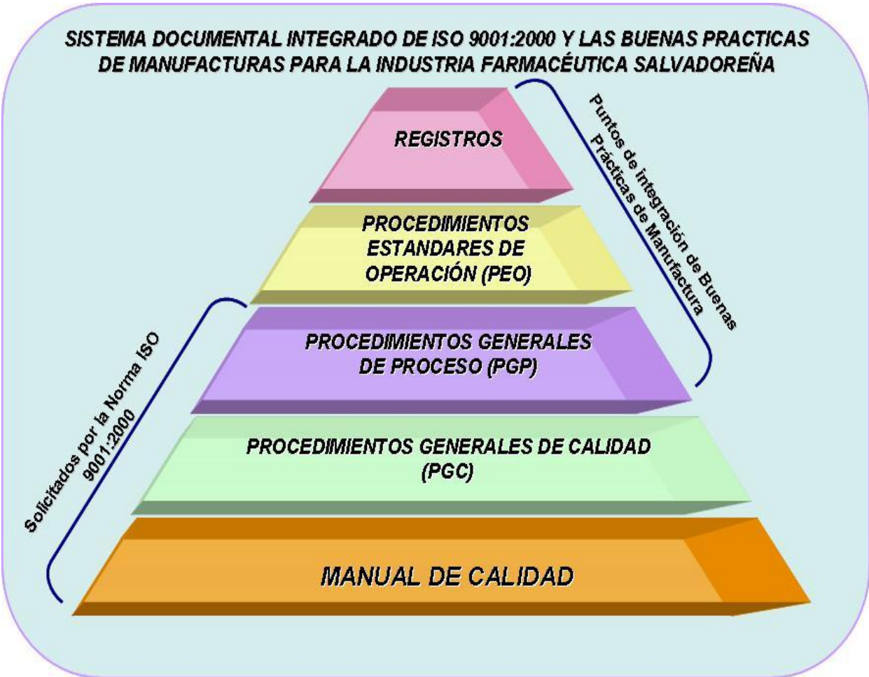
FIGURA No.10: ESTRUCTURA JERARQUICA DE LA DOCUMENTACIÓN DEL SISTEMA INTEGRADO DE CALIDAD ISO-BPMv PARA LA INDURSTRIA FARMACÉUTICA
