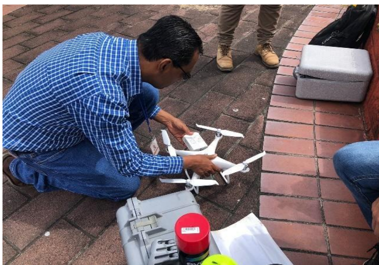
Figura 3.6.4.1: Realización del vuelo fotogramétrico con Dron. Fuente: Propia.
