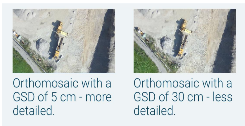
Figura 3.7.2: Distancia de muestreo terrestre (GSD). Fuente: https://www.pix4d.com/product/pix4dcapture .
