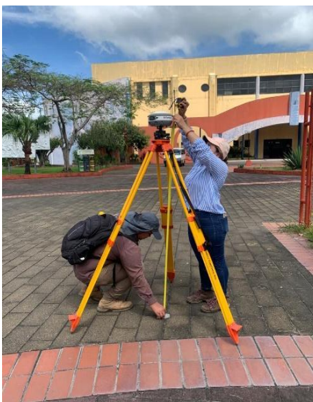
Figura 4.5.3: Medición de la altura de la base. Fuente: Propia.
