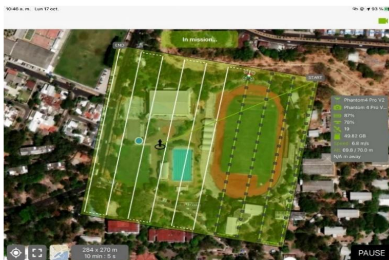
Figura 4.7.25: Ejecución del vuelo fotogramétrico. Fuente: Propia.
