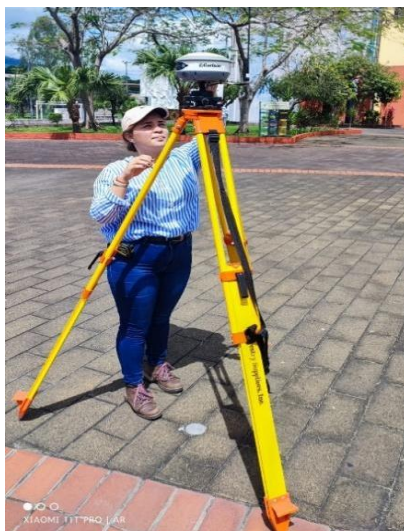
Figura 4.5.4: Arranque de la base. Fuente: Propia.
