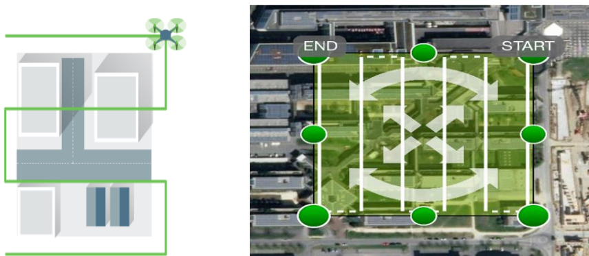
Figura 3.8.1.1: Misión cuadrícula para un vuelo fotogramétrico. Fuente: https://www.pix4d.com/product/pix4dcapture .
