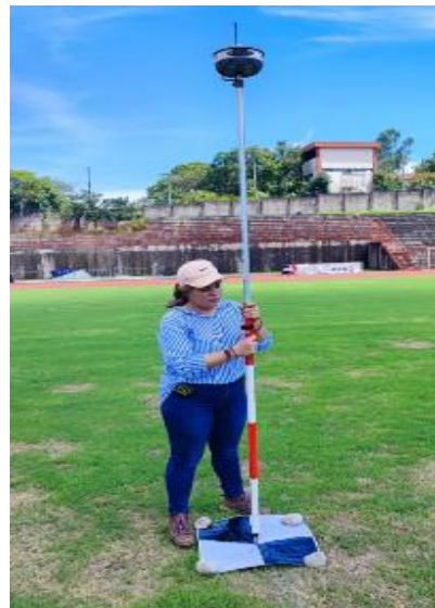
Figura 3.6.2.1: Puntos de Control fotogramétricos (PCF) para el levantamiento. Fuente: Propia.
