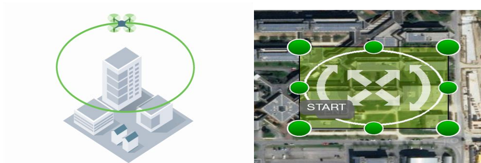
Figura 3.8.4.1: Misión circular para un vuelo fotogramétrico. Fuente: https://www.pix4d.com/product/pix4dcapture .
