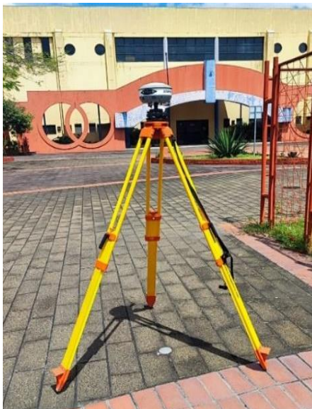
Figura 4.5.2: Instalación de la base en el punto con coordenadas conocidas. Fuente: Propia.
