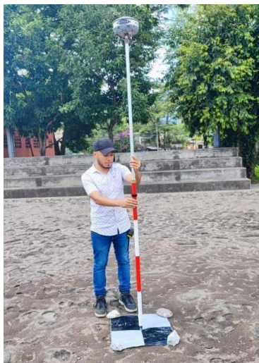
Figura 4.6.16: Medición de los PCF para el vuelo fotogramétrico. Fuente: Propia.
