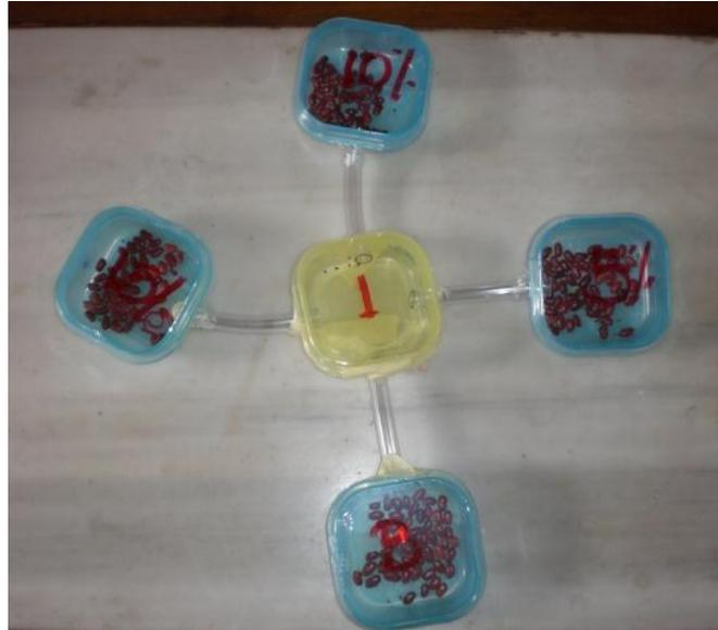
**Figura N° 24. Sistema de conteo para la realización de la prueba de Repelencia**
