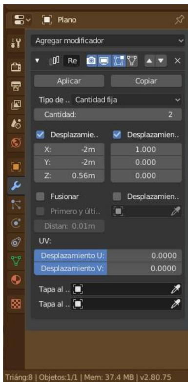
Debemos tomar en cuenta las configuraciones exactas y ubicar la repetición de modo que cuando se indique el número de repeticiones estas se coloquen de forma exacta para formar la escalinata. Por defecto el modificador viene con la opción de *Desplazamiento* desactivada, para lo que tendremos que activar la opción antes de ingresar los valores sobre el eje "X" -2m, "Y" -2m y sobre el eje "Z" 0.56m.
