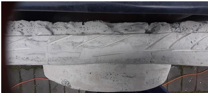
Figura 32. Trazado general de sisas con esmeril angular en relieve, vista aérea.
