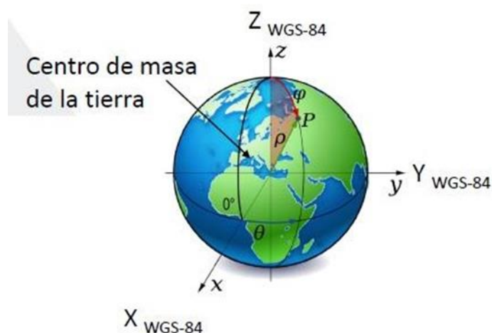
Figura 6. DATUM Global o Geocéntrico, ubicado en el centro de la tierra.
