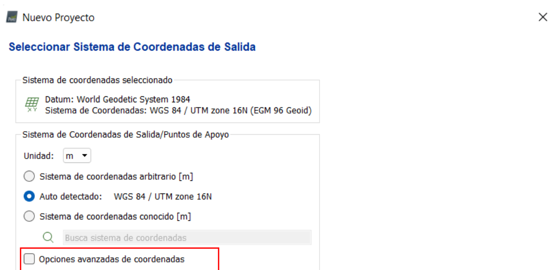
Figura 86: Configuración de sistema de coordenadas de salida.
