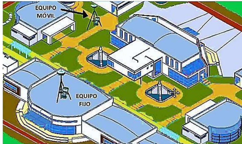
Figura 17. Ubicación recomendada para receptor Base y Móvil en técnica RTK.
