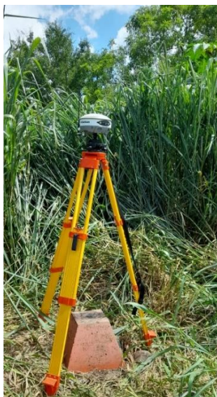
Figura 37. Estación base en punto FIA2.
