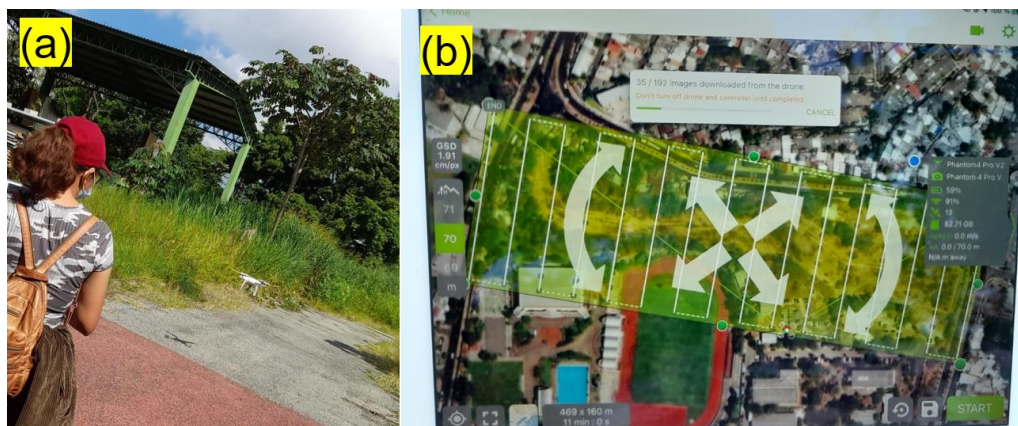
Figura 63: (a) Dron utilizado regresando después de finalizar el plan de vuelo. (b) Proceso de guardar imágenes tomadas del vuelo.
