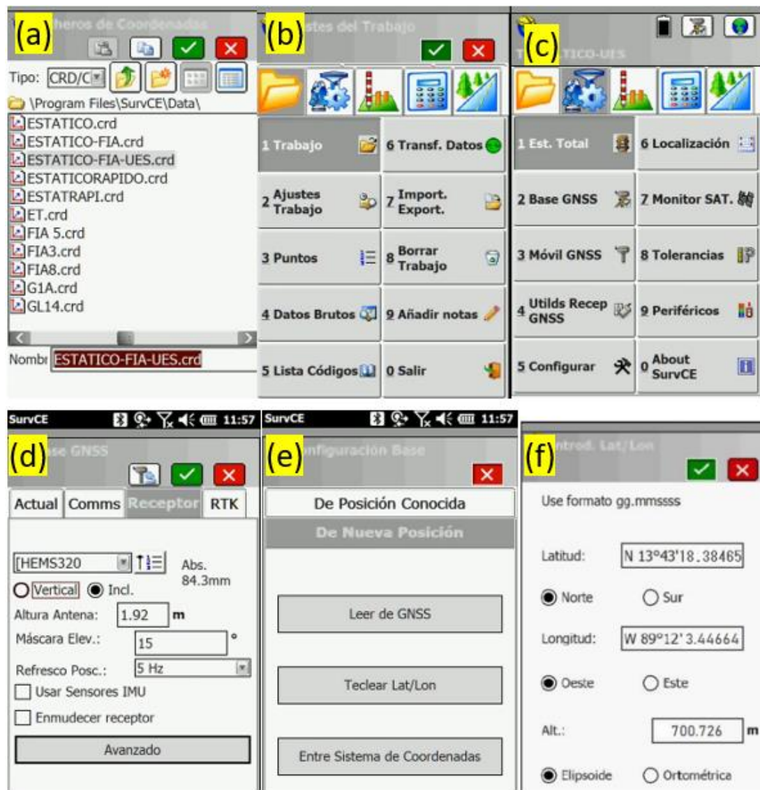
Figura 38: (a) Pantalla en la que se introduce nombre del proyecto. (b) Pantalla principal del programa en el colector. (c) Opciones de configuración en Survey. (d) Pestaña Receptor en configuraciones de Base GNSS. (e) Opciones de posición del receptor. (f) Parámetros de latitud y longitud.
