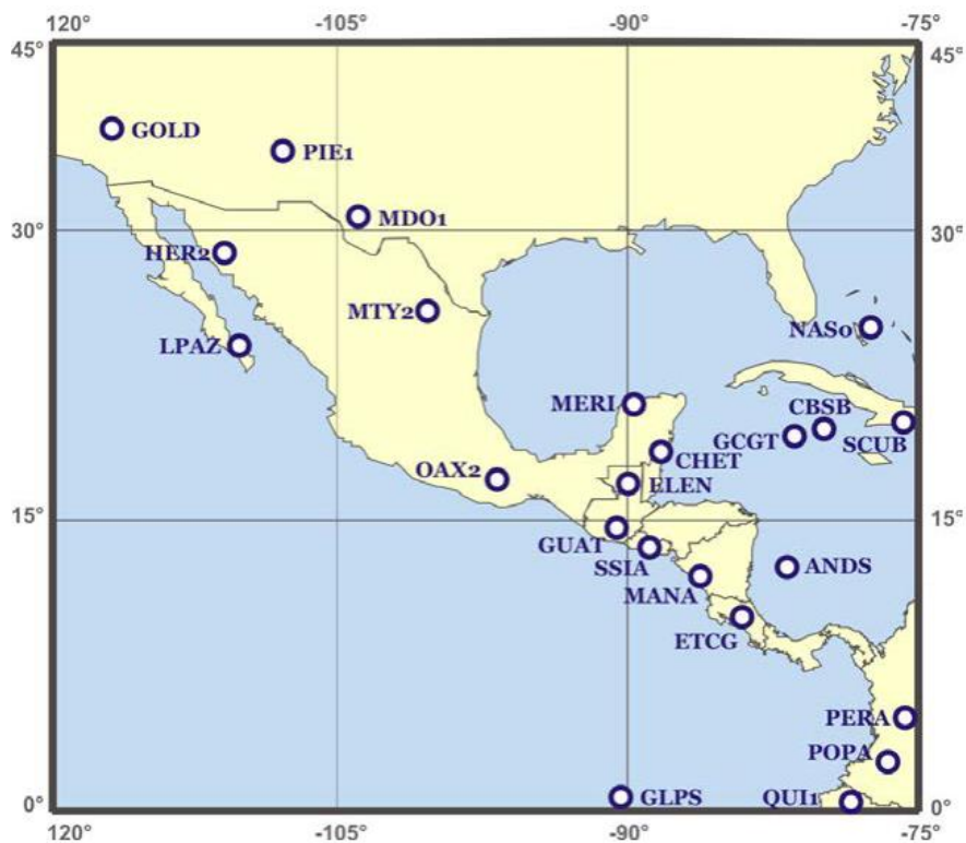
Figura 14. Estaciones SIRGAS-CON incluidas en el procesamiento de la Red Geodésica Básica Nacional de El Salvador (SIRGAS-ES2007). Las estaciones GOLD, PIE1, MDO1, ELEN, GUAT, SSIA, MANA, SCUB, GLPS, QUI1 también están incluidas en la red global del IGS.
