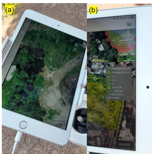
Figura 62: (a) Posición actual del dron en el vuelo. (b) Parámetros del vuelo.
