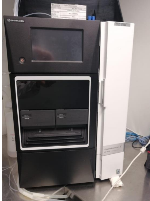
Equipo de Cromatografía Líquida de Alta Eficacia (HPLC por sus siglas en inglés) marca SHIMADZU modelo LC-2030.
