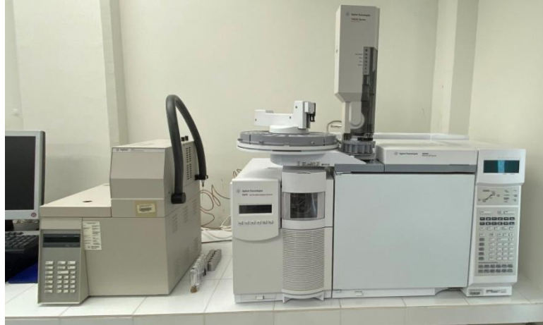
Figura N°3. Representación de un equipo cromatógrafo de gases acoplado a masas. 20
