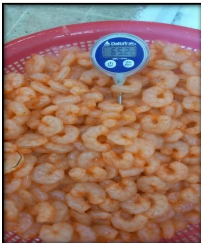
Figura. 42. Muestreo de temperatura interna del camarón.
