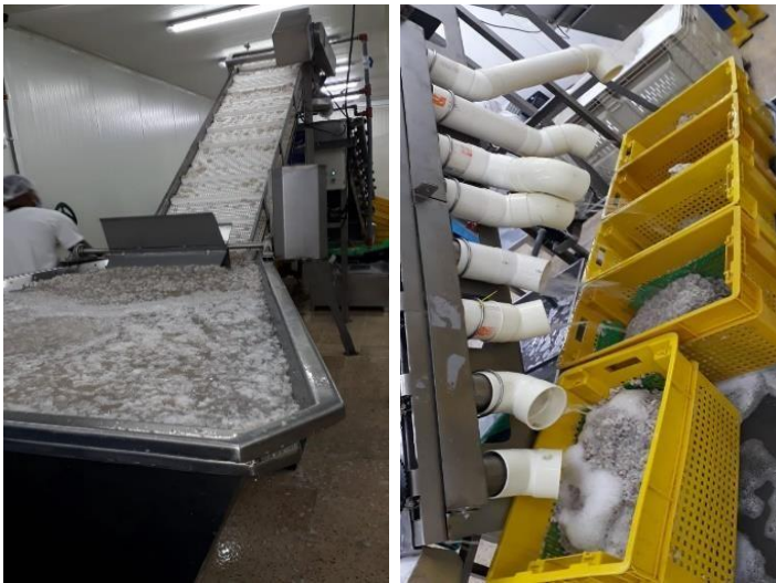
Figura 31. Tolva donde la máquina clasificadora extrae el camarón para su clasificación por tallas de la pomada.
