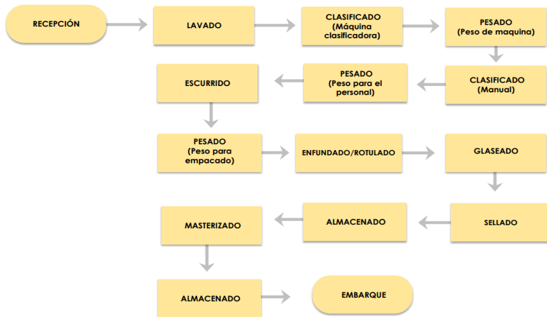
Figura 19. Flujo de proceso de pomada PUD - pelado con vena (blanca y negra).
