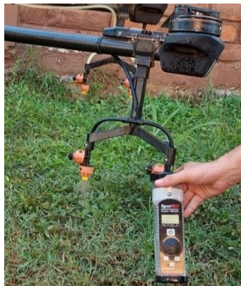
Figura 3. Evaluación de caudal de descarga.
