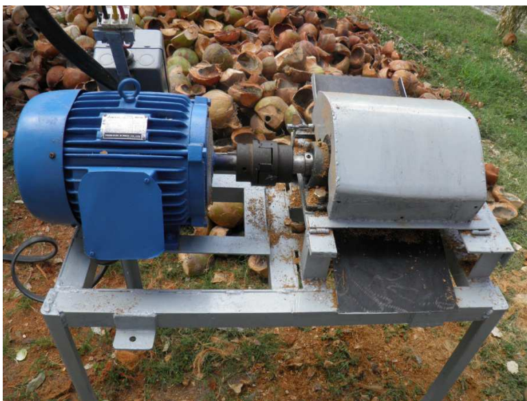
Figura A – 2. Máquina Desmenuzadora de Estopa de Coco.
