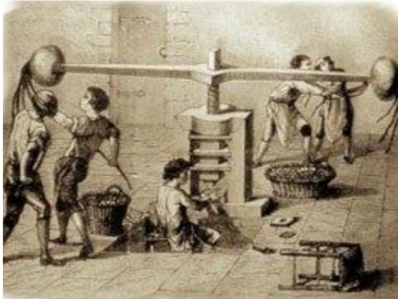
Fig. 1.18. Prensa para acuñado de moneda con balancín [14].
