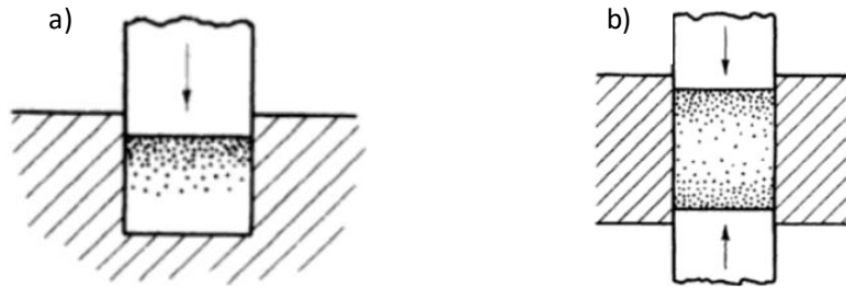
Fig. 1.10. Compactado de polvos con uno y dos émbolos.
