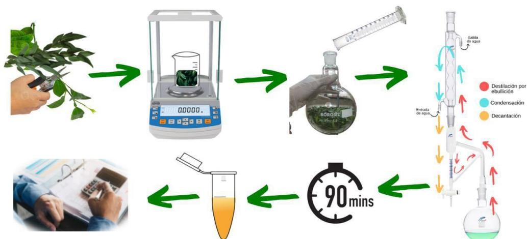
Figura N°1. Extracción de aceites esenciales utilizando el aparato Clevenger. Elaboración propia.
