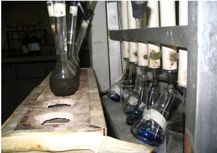
FIGURA Nº 3: Aparato de destilación con muestras de leche digeridas.
