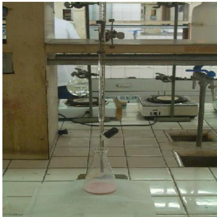
FIGURA Nº 9: Obtención del punto final de la titulación
