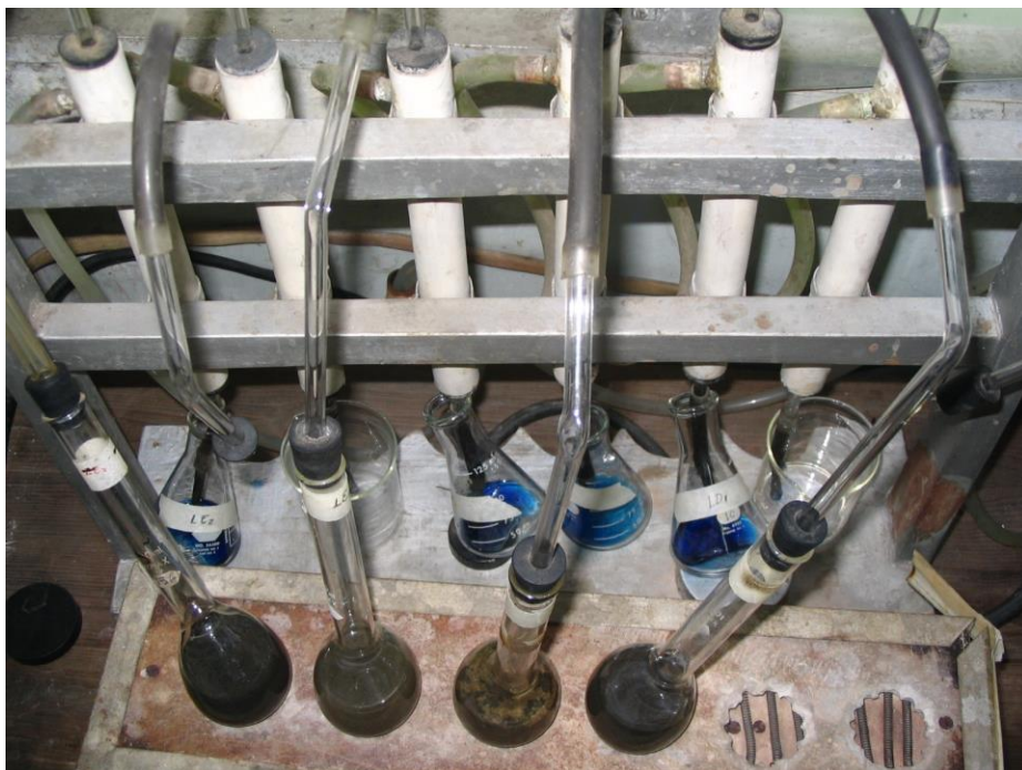
FIGURA Nº 4: Obtención de Nitrógeno por destilación
