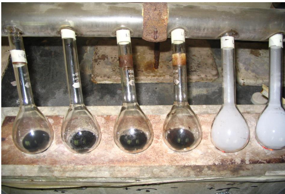
FIGURA Nº 1: Aparato digestor con muestras de leche a analizar.
