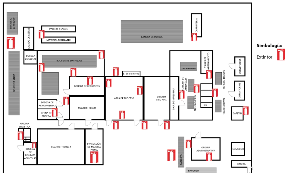
Ilustración 3: Ubicación de extintores
