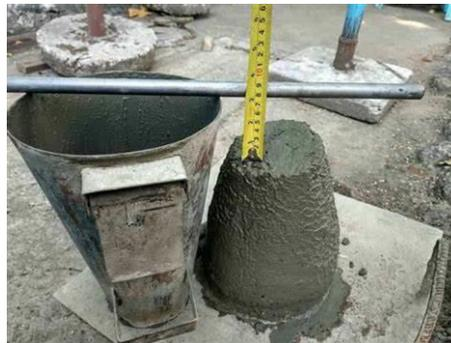
Ilustración 11. Prueba de Revenimiento.
