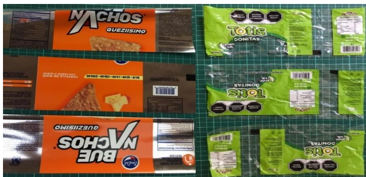
Figura 3.13 Muestra A (Izquierda) y Muestra B (derecha) para ensayos de adherencia.
