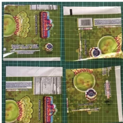
Figura 3.17 Empaque impreso a utilizar como muestra de prueba de resistencia química.
