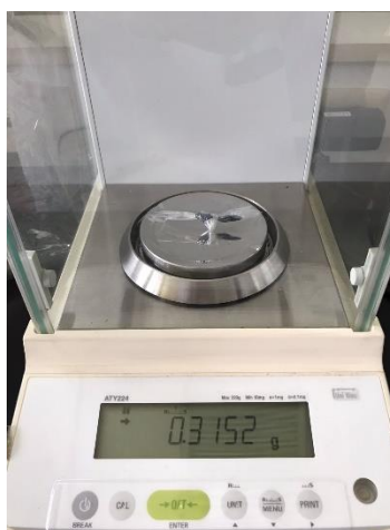
Figura 3.8 Medición de masa de cada muestra.
