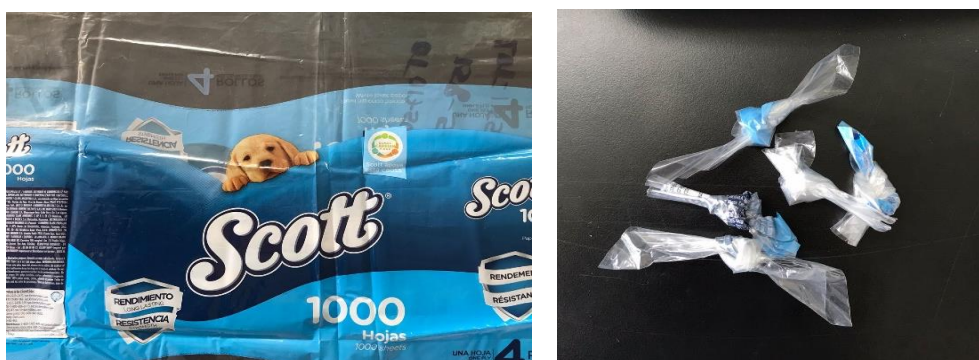
Figura 3.7 A) Muestra de empaque impreso. B) Muestra preparada para realizar mediciones de prueba de gramaje.
