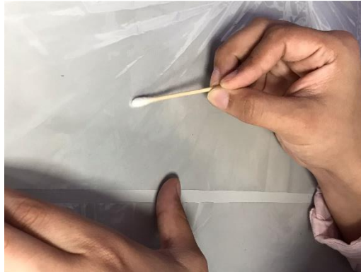
Figura 3.22 Uso de hisopo para prueba de tensión superficial.
