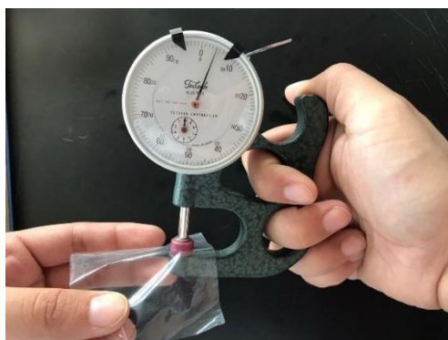
Figura 3.6 Manipulación del micrómetro.
