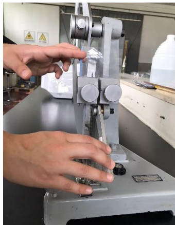
Figura 3.12 Manipulación del equipo Elmendorf.
