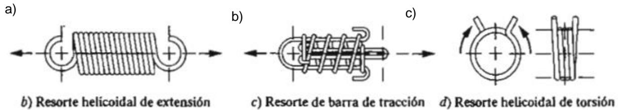
Fig. 1.3. Diversos tipos de resortes según su forma: a) Resorte helicoidal para tracción; b) Resorte de barra para tracción; y c) Resorte helicoidal para carga a torsión [4]
