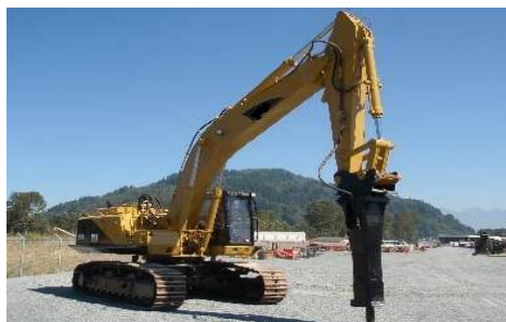
Fig. 3.33 Martillo hidráulico en retroexcavadora
