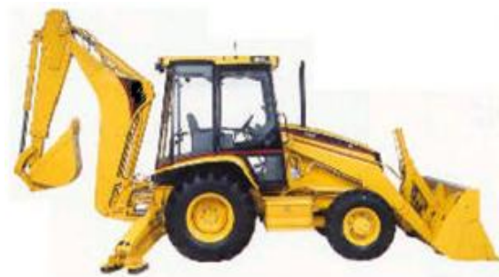
Fig. 3. 42 Retroexcavadora sobre ruedas
