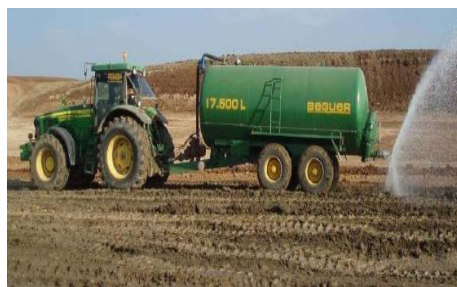
Fig. 3. 24 Cisterna halada por tractor agrícola
