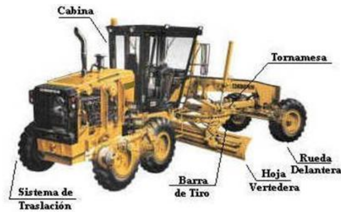
Fig. 3.34 Partes de una Motoniveladora
