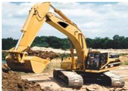
Fig. 3.30 Excavadora de oruga
