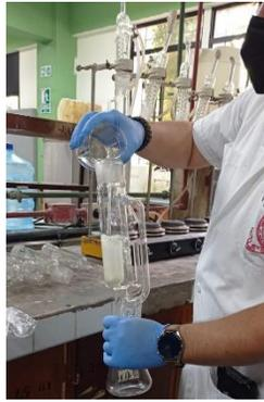
b-5. Preparación de muestras y equipo para la determinación de extracto etéreo.
