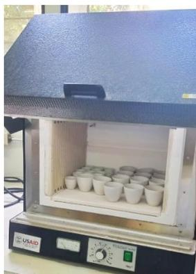
b. Colocación de los crisoles en el horno de mufla.
