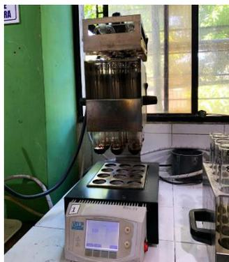
b. Colocación de los tubos con muestra en el equipo de digestión de Kjeldahl.
