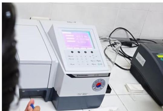
a. Lectura de las muestras en el Espectrofotómetro para determinación de fósforo.
