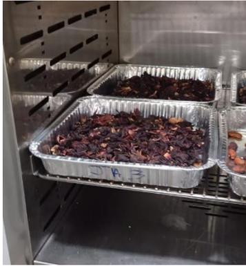
d. Colocación de las muestras en estufa de aire reforzado.
