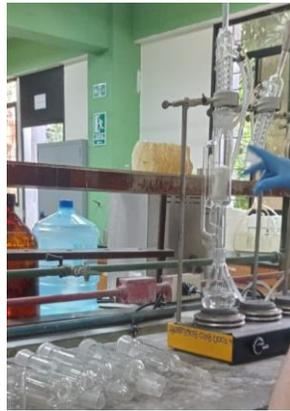
c-5. Armado del equipo (balón, corneta, condensador).
