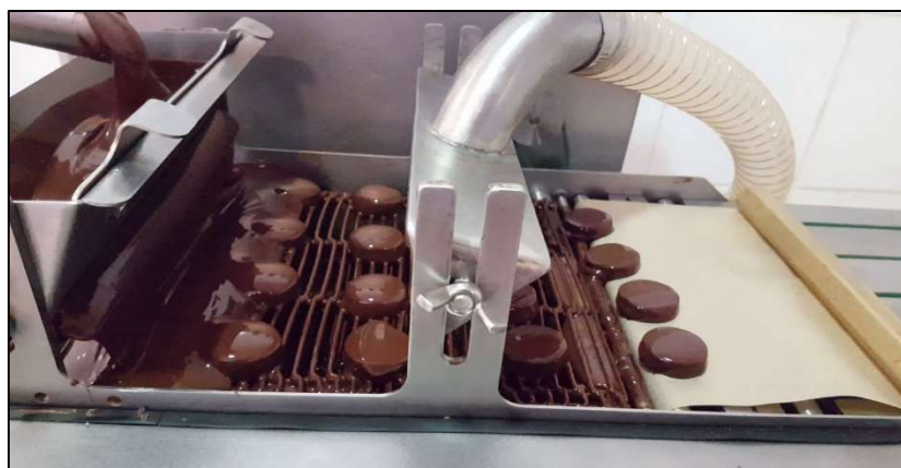
Figura N°4. Sistema de bañado de chocolate para galletas. (15)
