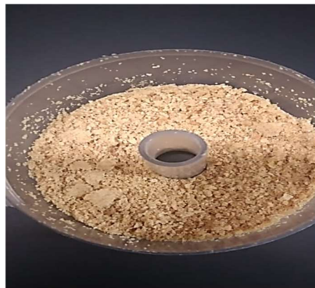
Figura N°14. Trituración de las muestras en triturador eléctrico Fuente: Elaboración propia
