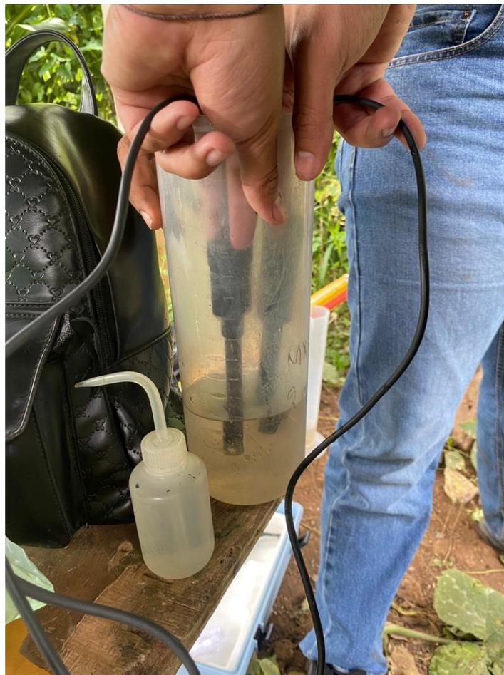
Anexo 6. Toma de parámetros al agua lluvia cosechada con sonda multiparamétrica.
