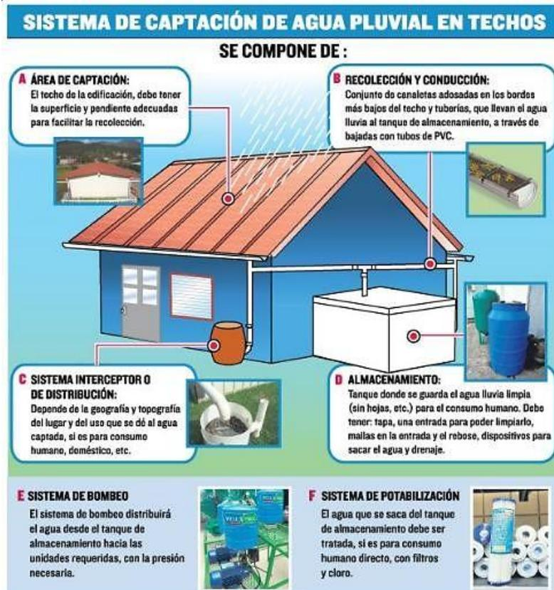
Figura 2. Partes del Sistema de captación de agua de Lluvia
