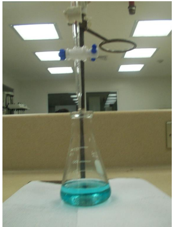
Figura N° 3: Viraje de color de violeta a verde esmeralda en las valoraciones usando como indicador cristal violeta TS con titulante de \text{HClO}_4 0.1N VS y 0.05N VS de las siguientes muestras:
