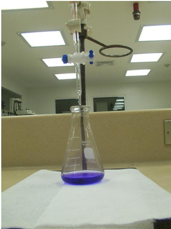
Figura N° 4: Viraje de color de violeta a incoloro en las valoraciones usando indicador cristal violeta TS con titulante de NaOH 0.1N VS en metanol de las siguientes muestras:
