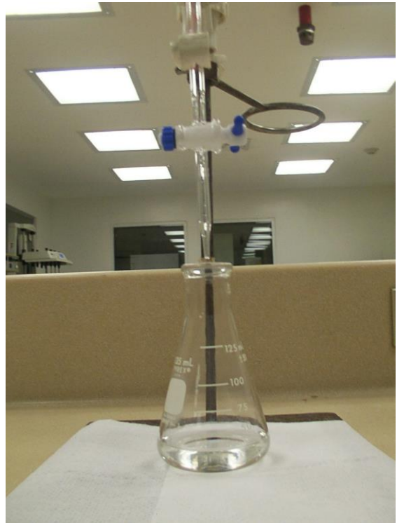
Figura N° 4: Viraje de color de violeta a incoloro en las valoraciones usando indicador cristal violeta TS con titulante de NaOH 0.1N VS en metanol de las siguientes muestras:
