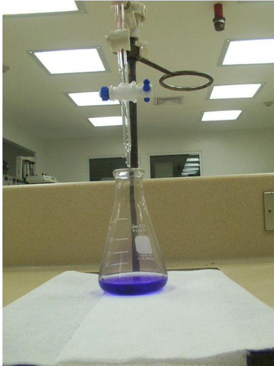
Figura N° 5: Viraje de color violeta a azul en la valoración usando como indicador cristal violeta TS y titulante \text{HClO}_4 0.1N VS de la siguiente muestra:
