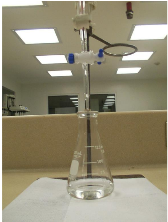
Figura N° 2 Viraje de incoloro a rosado tenue en la valoración usando como indicador fenolftaleina TS con titulante NaOH 0.5N VS en metanol y realizando la retrovaloración con H 2 SO 4 0.5N VS en metanol virando de rosado a incoloro:
