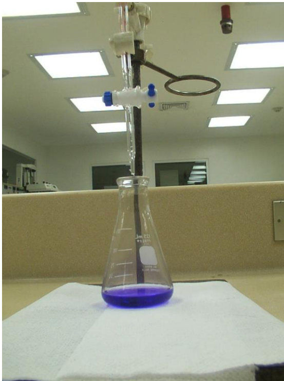
Figura N° 3: Viraje de color de violeta a verde esmeralda en las valoraciones usando como indicador cristal violeta TS con titulante de \text{HClO}_4 0.1N VS y 0.05N VS de las siguientes muestras:
