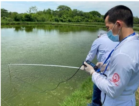
Figura N°30. Evaluación de oxígeno disuelto, pH y temperatura in situ. Fuente: elaboración propia
