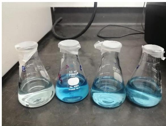
Figura N°40. Resultados del análisis fotométrico para determinación de amonio. Fuente: elaboración propia
