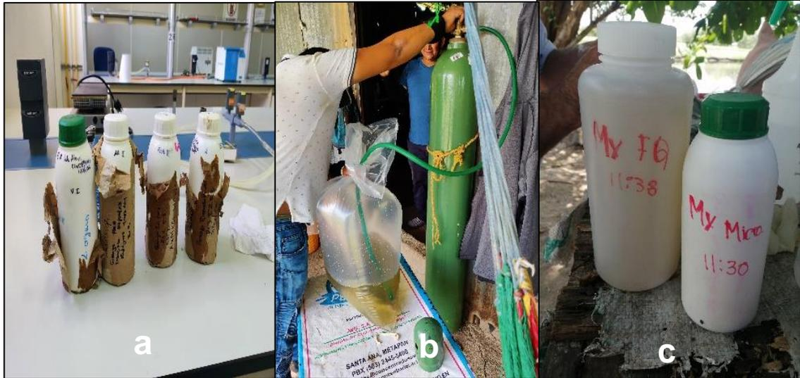
Figura N°23. Recolección y transporte de muestras, a) agua para análisis microbiológico b) tilapias frescas, c) muestras de aguas para análisis fisicoquímico. Fuente: elaboración propia
