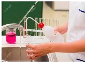
Lavar los tubos de ensayo con agua desmineralizada
