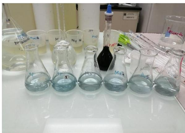
Figura N°33. Resultados del análisis volumétrico para determinar dureza. Fuente: elaboración propia
