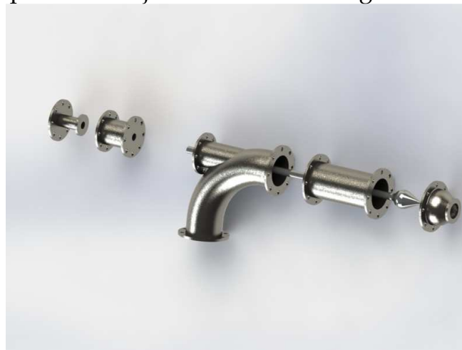
Ilustración 2.4.3.1: Renderizado del inyector mostrando las juntas atornilladas.
