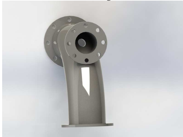
Ilustración 2.4.4.1 Detalle del codo del inyector
